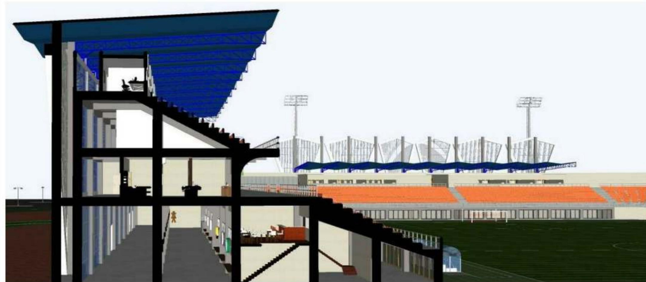
7. SECCION TRANSVERSAL DE GRADERIAS
