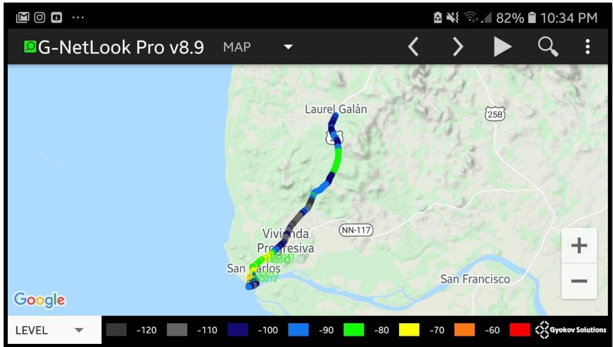
Figura 4 Vista general de la medición Throughput DL/UL realizada en San Carlos – Laurel.
