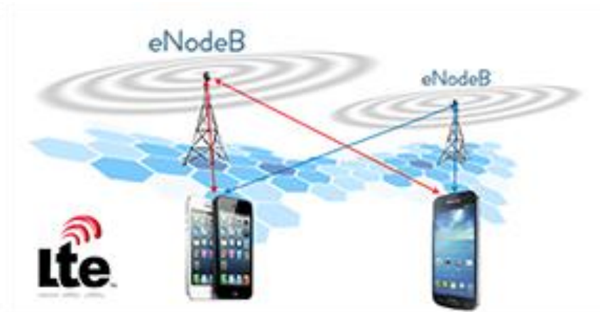
Figura 3.1 Handover entre E-Node B
