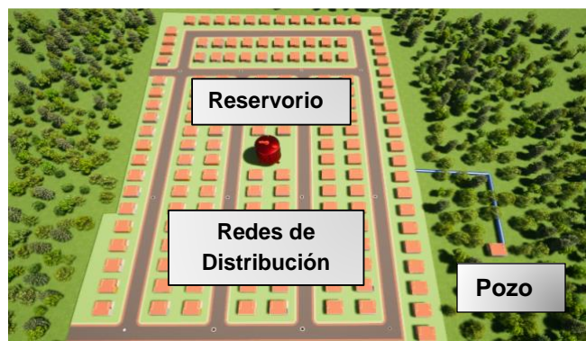
Figura 6. Representación de bombeo contra la red
