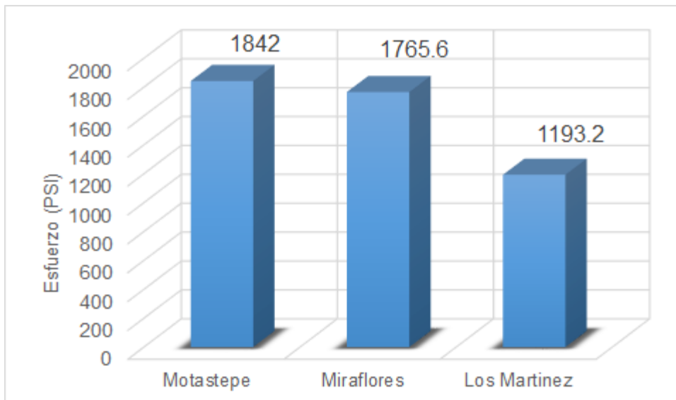
Ilustración 39 Relación agua/cemento de 0.63
