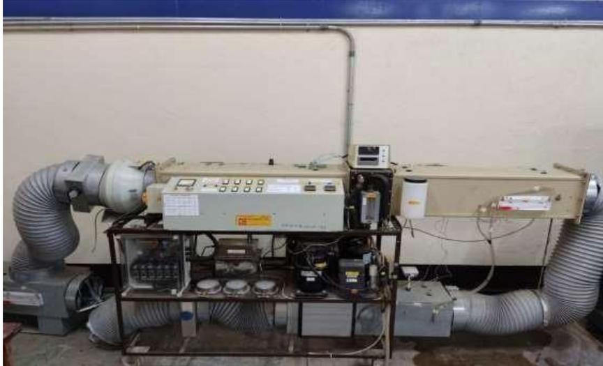
En la unidad de laboratorio de aire acondicionado A660 se realizó el diagnóstico del funcionamiento, en el cual se determinaron las siguientes fallas:
