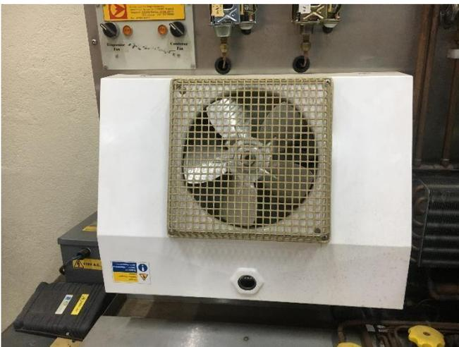
**Figura N°3:** Evaporador de aire forzado.
