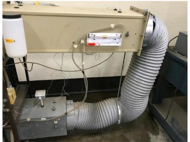
**Figura N°12:** Manómetro Inclinado.
