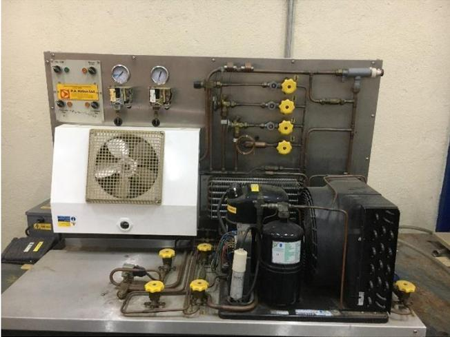
**Figura N°1:** Unidad de laboratorio de refrigeración y aire acondicionado de ciclo inverso R808.
