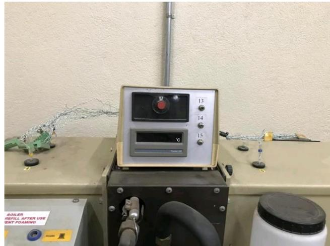
Figura N°10: Indicador de temperatura.
