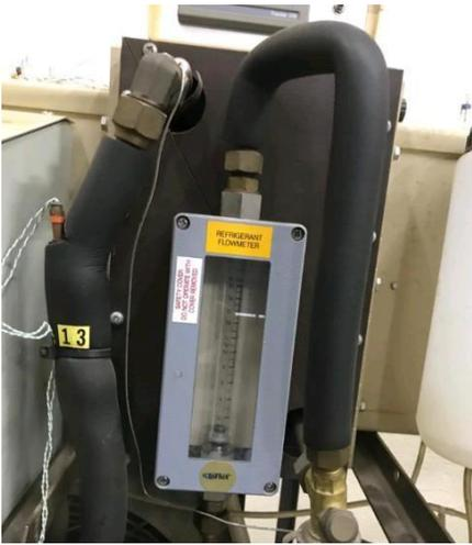
Figura N°8: Caudalímetro de refrigerante.
