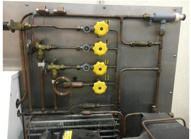
**Figura N°2:** Dispositivos de expansión, válvulas, ecualizadores externo e interno y tubo capilar.
