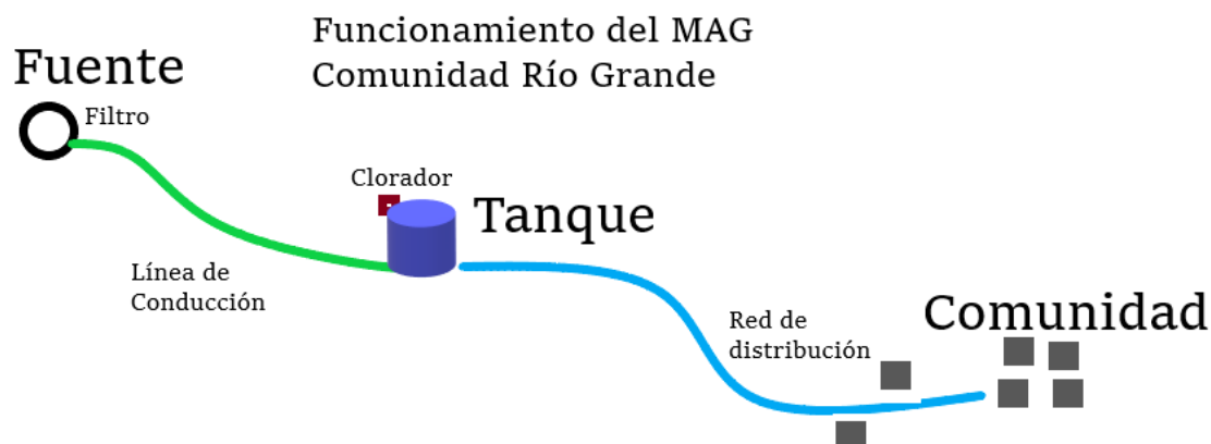
Ilustración 4. Esquema de funcionamiento del sistema
