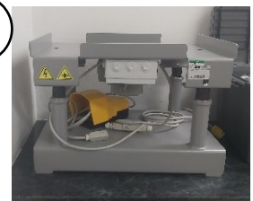
Mesa vibradora de concreto.
