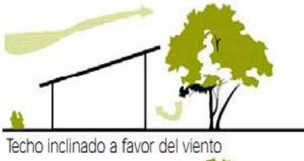
Figura No. 46. Techo Inclinado a favor del viento. Fuente: Manual de diseño para edificaciones energéticamente eficiente en el trópico.
