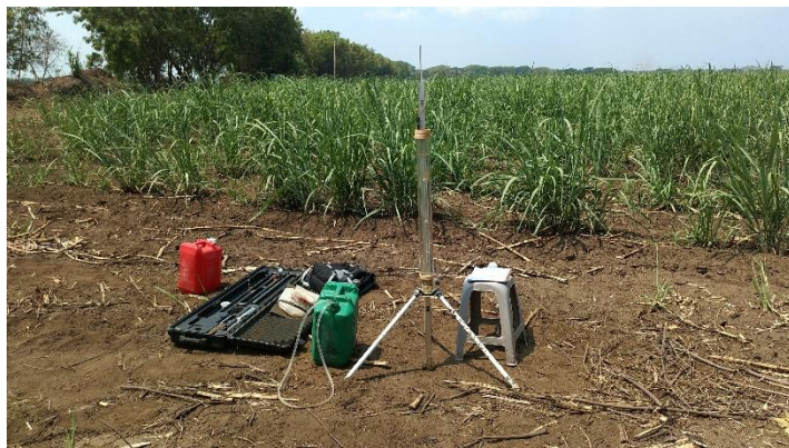
Foto 11. Prueba de infiltración Finca Holanda
