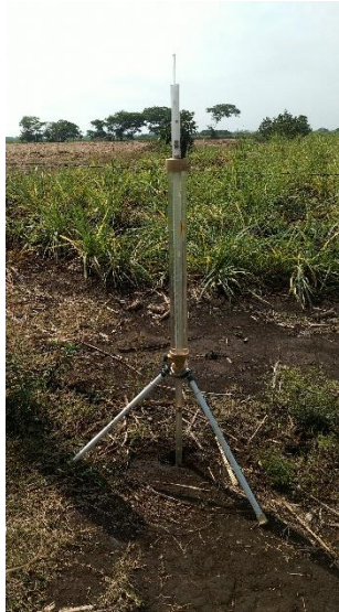
Foto 9. Prueba de infiltración Cerca al Pozo Silva
