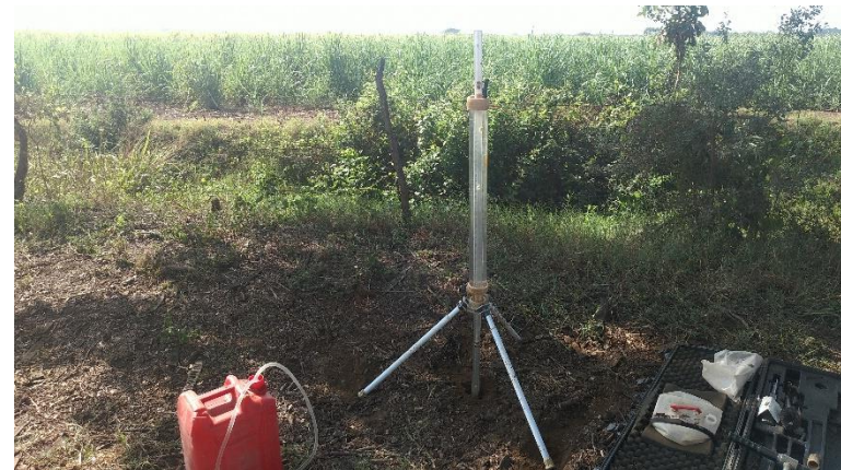
Foto 12. Prueba de infiltración El Pedregal
