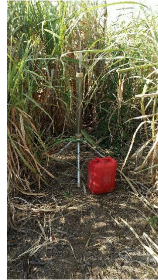
Foto 10. Prueba de infiltración Venecia
