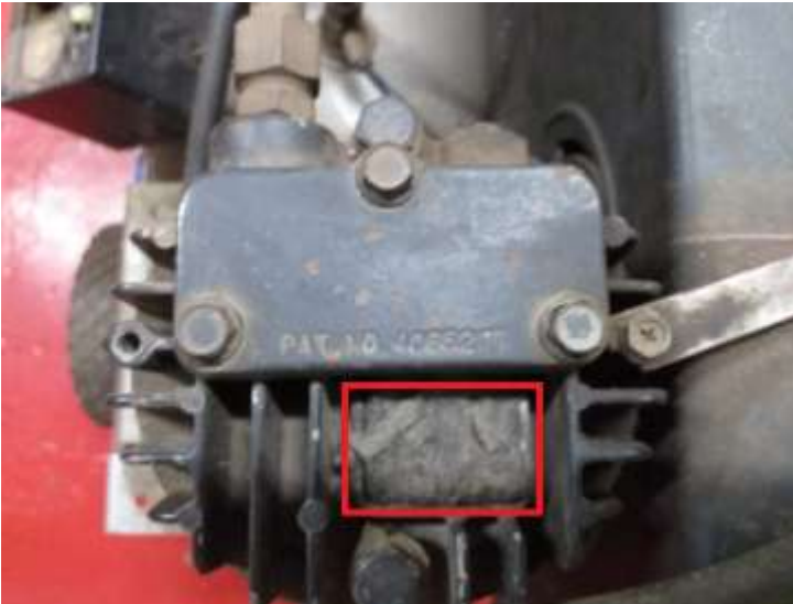
Fig. 6.1.3-5 Filtro de Aire
