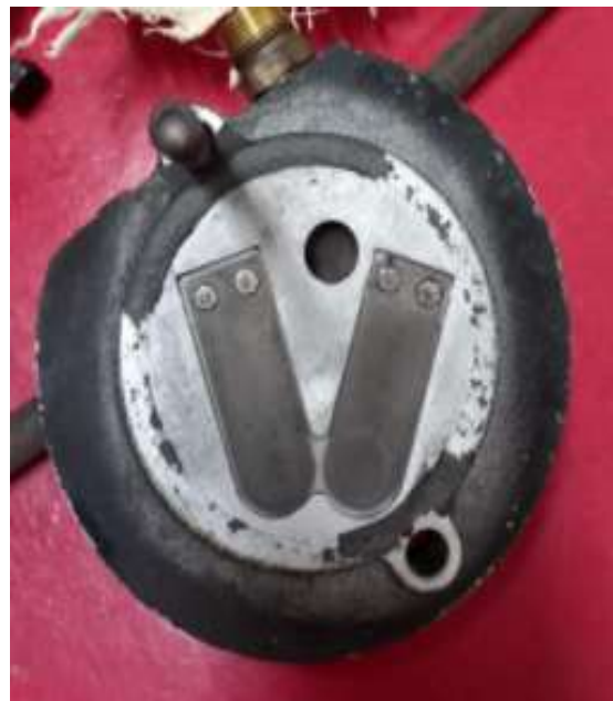
Fig. 6.1.3-12 Descarbonado de Válvulas Flappers
