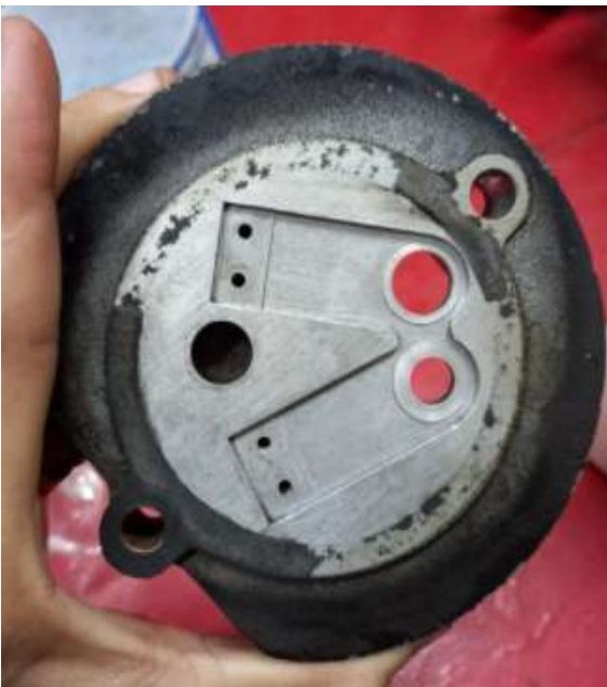
Fig. 6.1.3-12 Descarbonado de Válvulas Flappers
