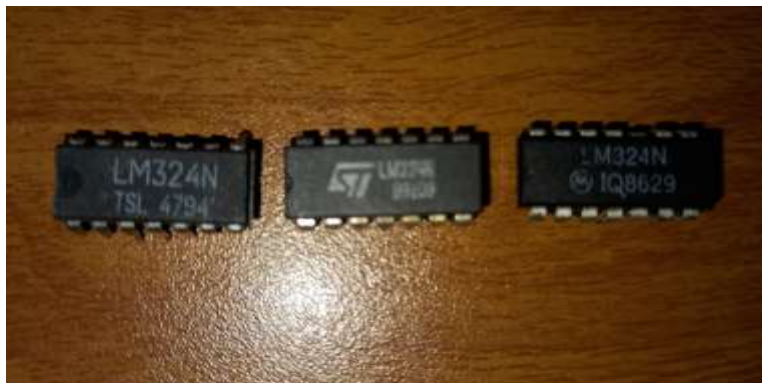
Fig. 6.1.3-3 Circuito Integrado LM324N
