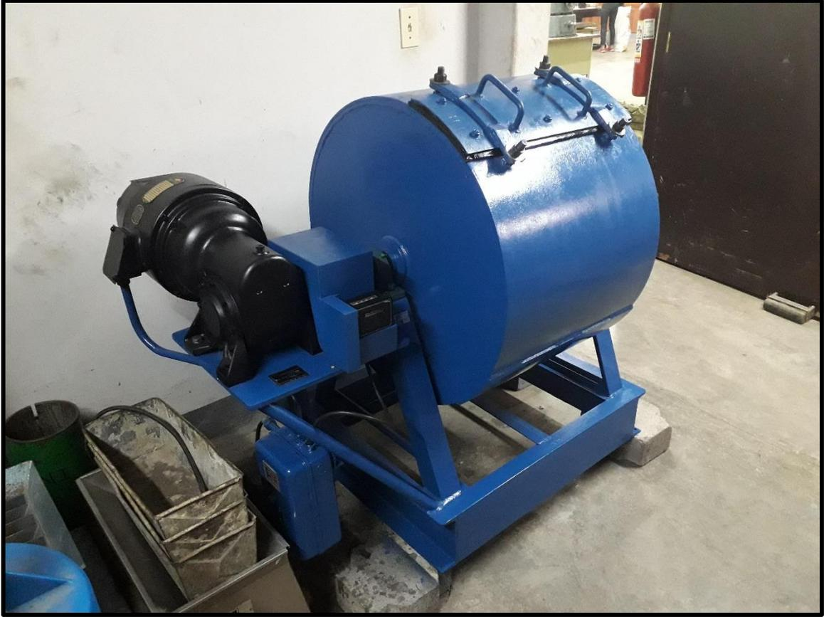
**Estado final de la Máquina de Abrasión de los Ángeles después del mantenimiento integral.**
