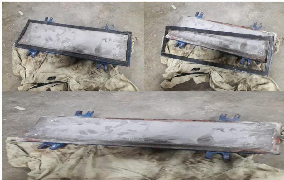
**Figura 20:** Empaque de la tapa del cilindro.
