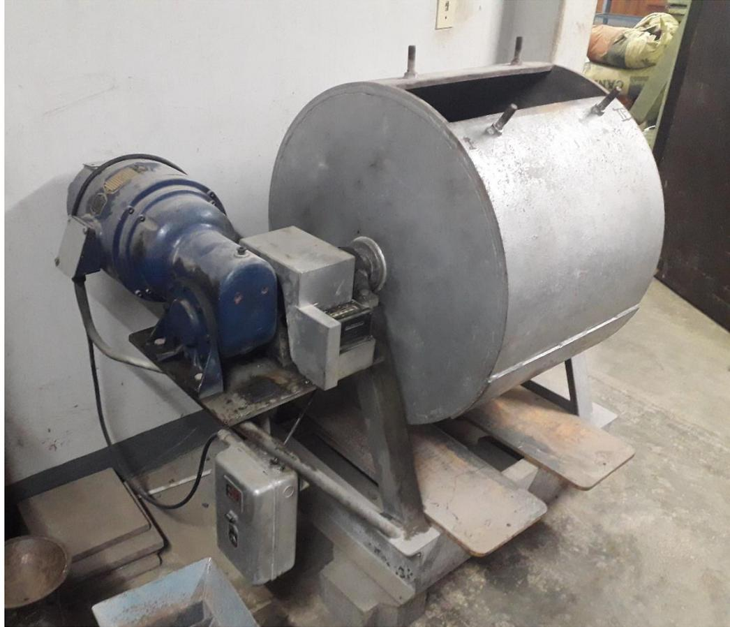
**Figura 12:** Estado inicial de la Máquina de Abrasión de los Ángeles.
