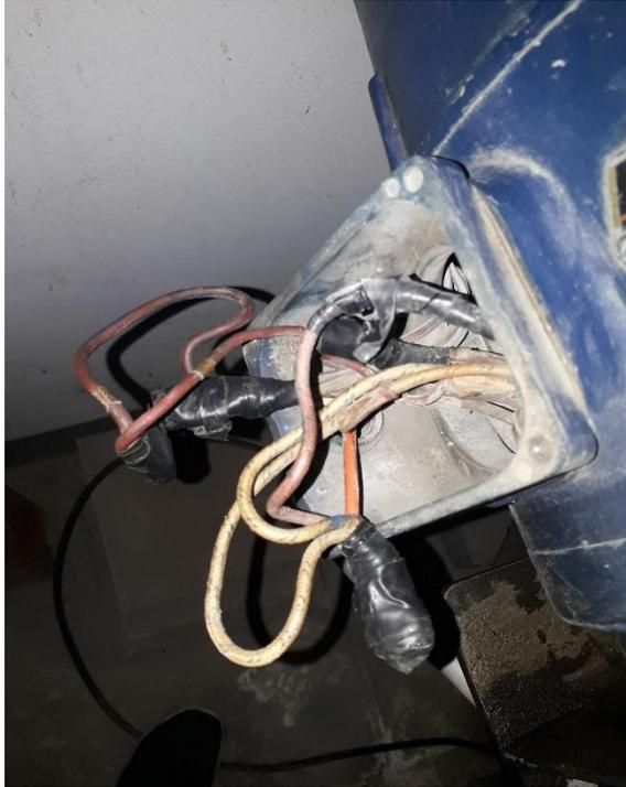
**Figura 14:** Líneas eléctricas, conexión al motor eléctrico.
