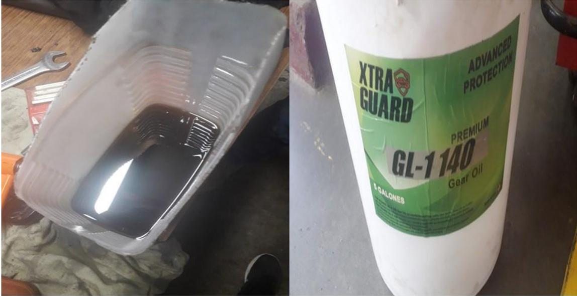
**Figura 28:** Aceite lubricante de caja reductora.
