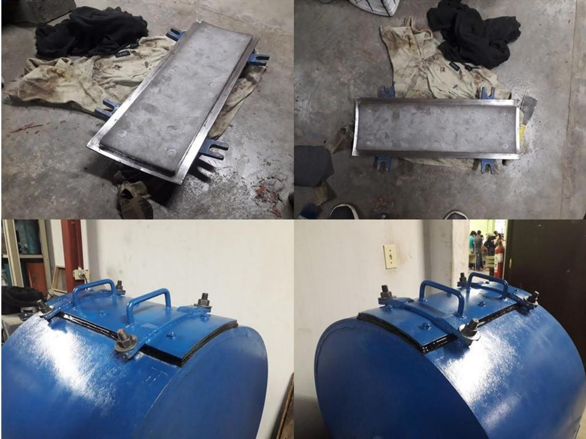
**Figura 32:** Tapa de cierre del cilindro.
