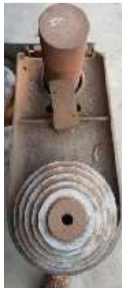
Figura N°13. Mecanismo movimiento principal
