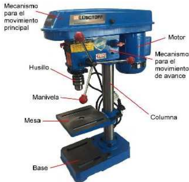
Fig. N°1 componentes principales de un taladro de banco
