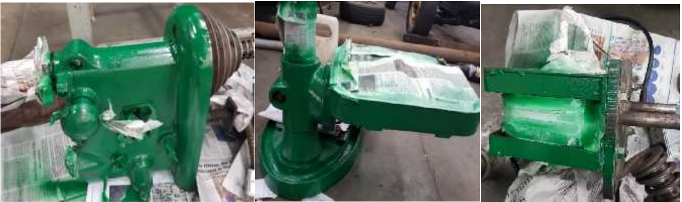
Fig.N°27. Aplicación de pintura base.
