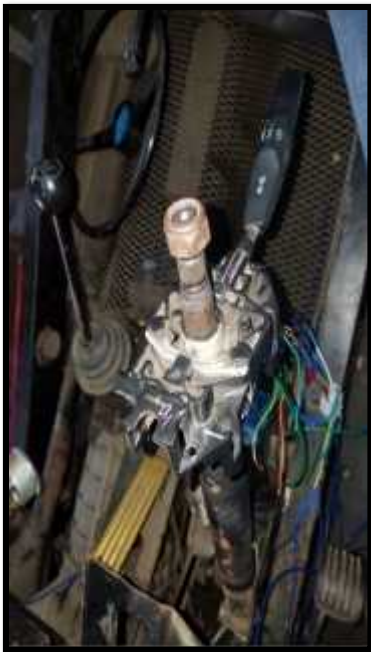
Imagen 16 Adaptación de mando de luces
