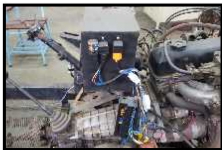
Imagen 8 caja de fusibles y relé
