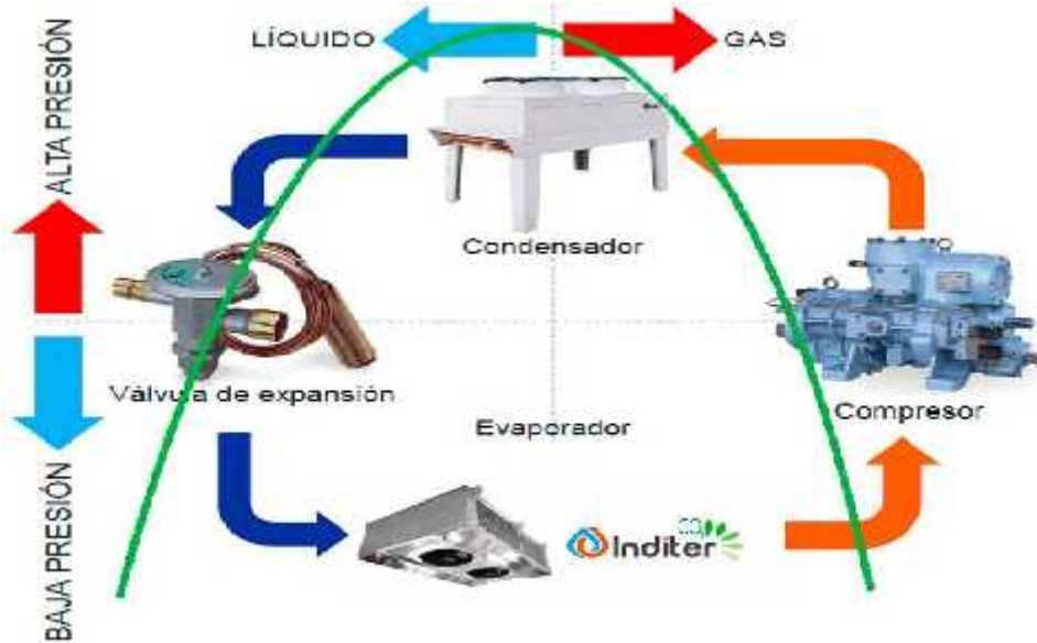
Figura 1: Ciclo de Refrigeración. Nota: Tomado de Inditer, 2020
