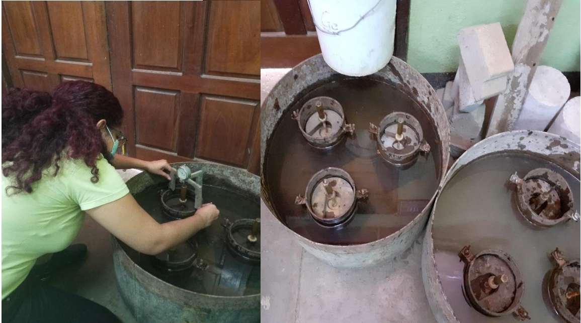
Imagen 30: Lectura del hinchamiento y sumersión en agua de los CBR por 96 hr.
