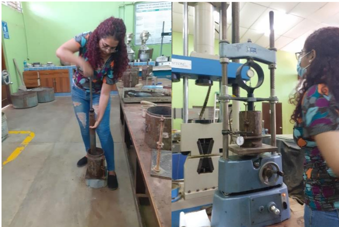
Imagen 8: Compactación de la muestra y lectura del ensayo CBR
