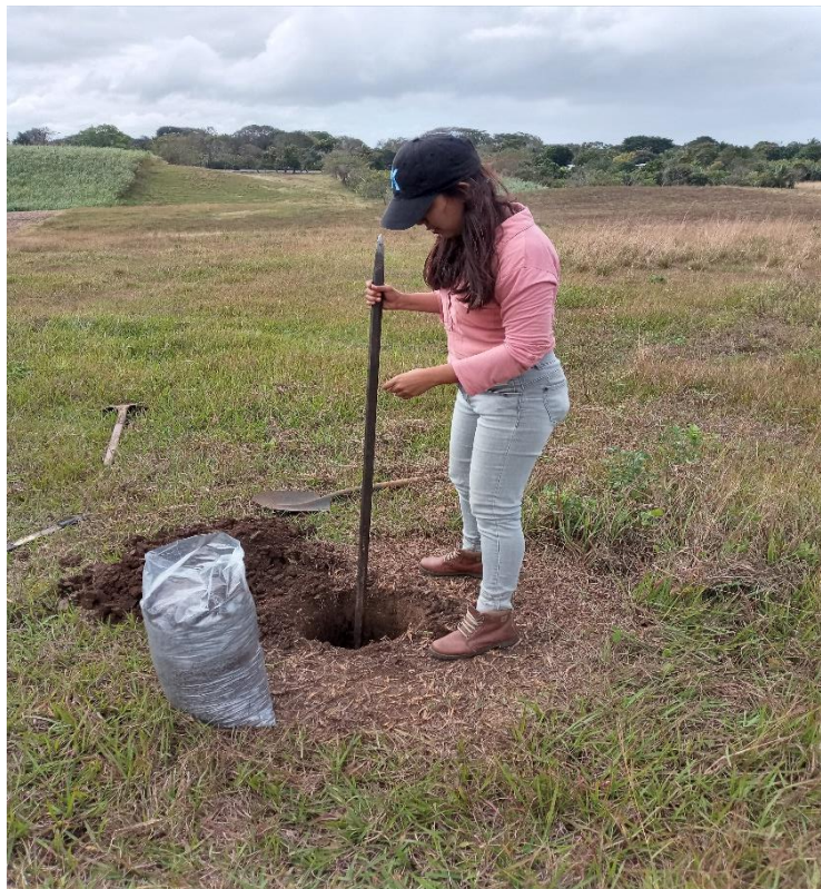
Imagen 14 Sondeo manual de 1.5m de profundidad.
