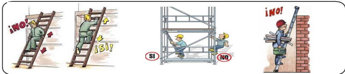
Ilustración 48: Andamio; Ascenso y Descenso
