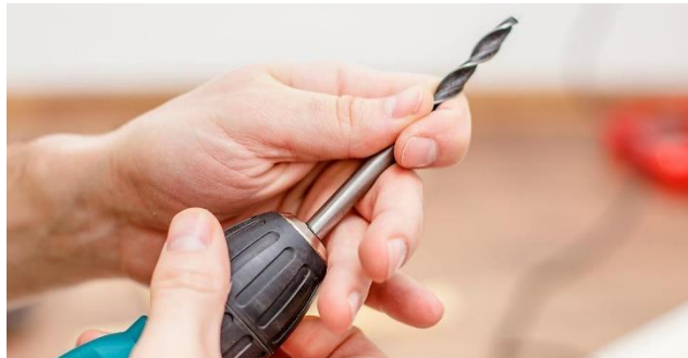
Ilustración 13 : Instalación de broca
