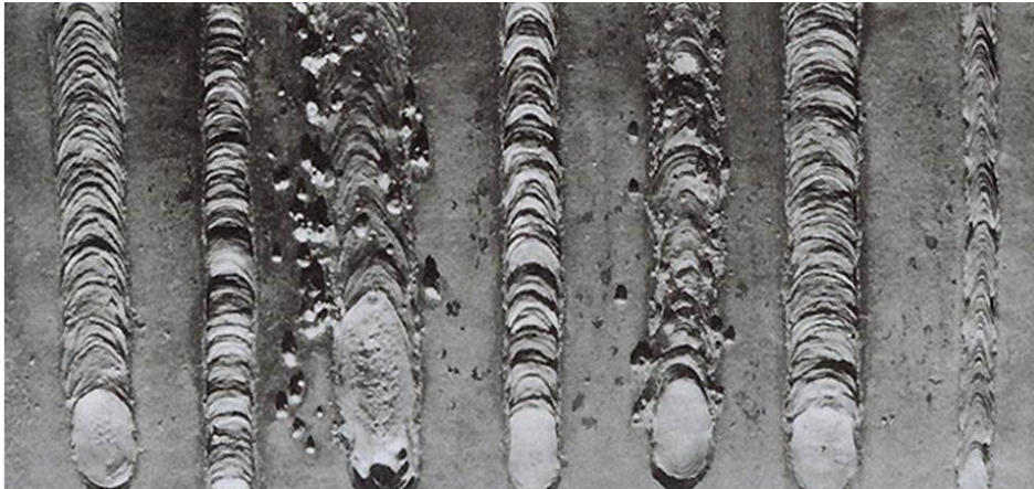
Ilustración N°18: Cordones de soldadura.
