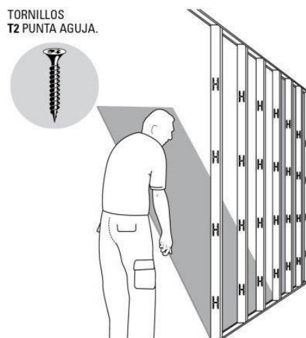
Ilustración N°23: colocación de placas de yeso.
