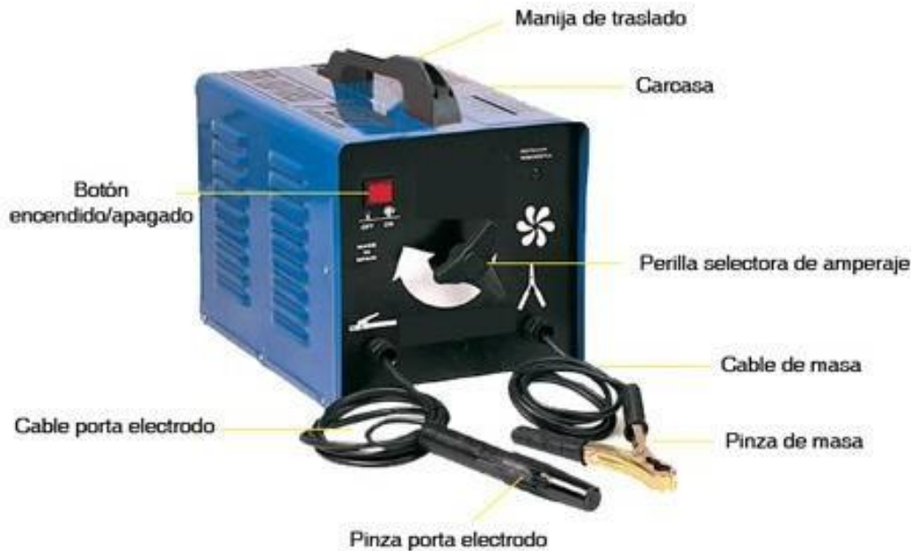
Ilustración N°13: Partes del soldador Eléctrico.
