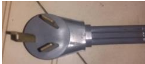
Ilustración N°8: Cable de corriente trifásico 220v.
