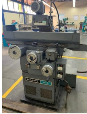
Figura 4. Rectificadora plana Fuente: Propia 2020.
