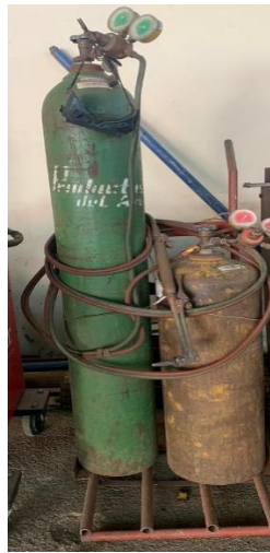
Figura 15. Soldadura oxiacetilénica Fuente: Propia 2020
