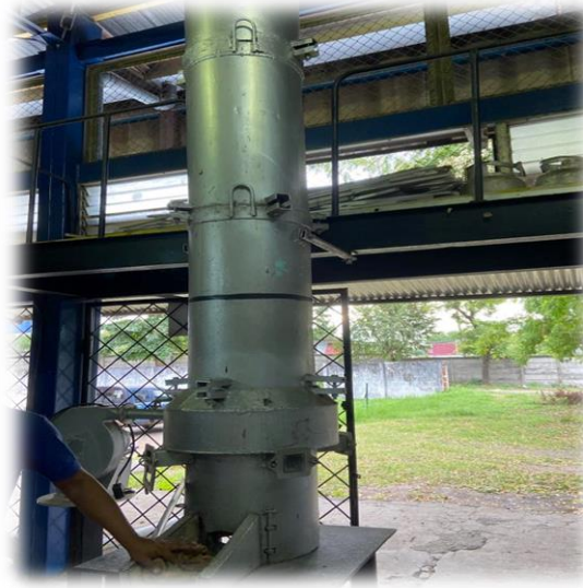
Figura 9. Horno de Cubilote Fuente: Propia 2020
