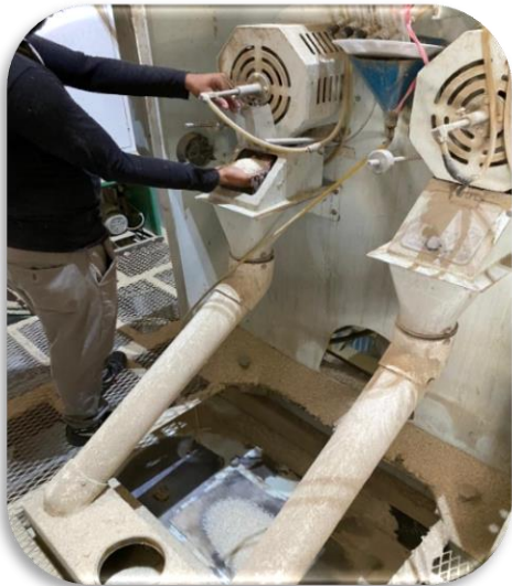
Ilustración 9. Operador sin equipo de protección personal
