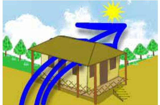
En climas muy cálidos y húmedos: Al desarrollar una planta lineal y abierta, se está aprovechando al máximo la acción de los vientos y se refrescaría la temperatura interior alta, se liberaría el exceso de humedad ambiental.
