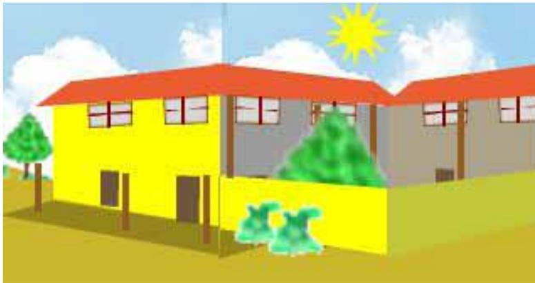
En clima cálido-húmedo: En una planta abierta con patio mediante la ventilación se libera la humedad, pero conserva cierto aislamiento
