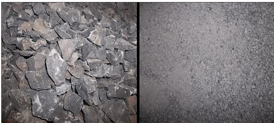
Fig. 3 Imagen de la izquierda corresponde al agregado grueso (grava) y la imagen de la derecha al agregado fino (material cero). Imagen, fuente propia.
