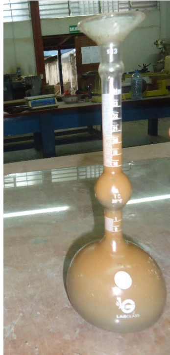
Imagen 18. Ensayo de determinación de la gravedad específica del cemento. Fotografía: Fuente propia.
