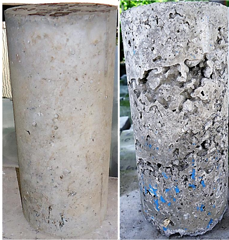
Fig. 10. En la imagen de la izquierda se observa la probeta bien consolidada y homogénea, mientras que en la probeta de la derecha se observa un mal acomodamiento de las partículas producto de una mala consolidación al momento de confeccionar el espécimen. Imagen: Fuente propia.
