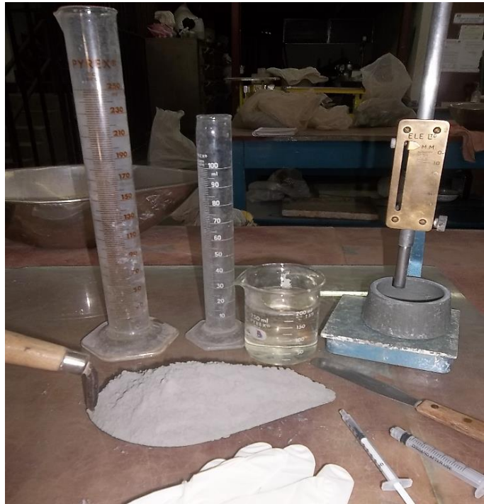
Fig. 13. Materiales y equipos usados en los ensayos de determinación de la consistencia normal del cemento hidráulico y tiempos de fraguado. Imagen: Fuente Propia.
