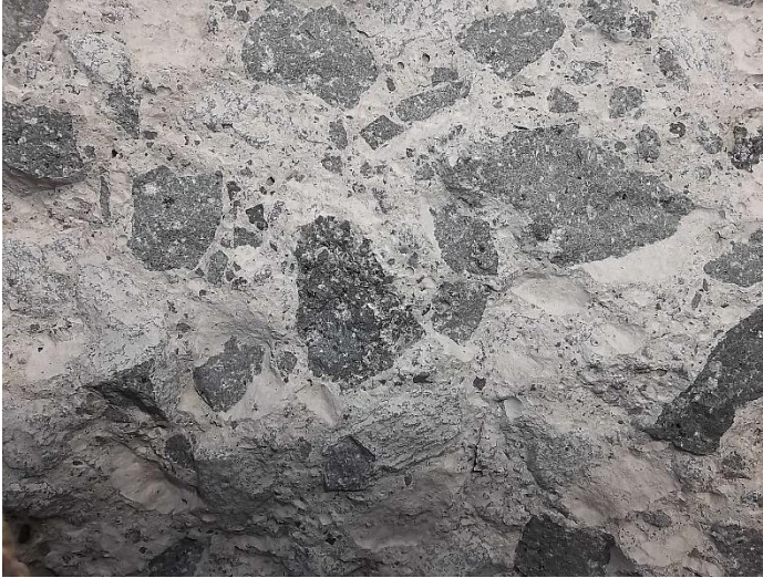
Fig. 11. Sección transversal del concreto endurecido, confeccionado con grava basáltica triturada. Imagen: Fuente propia.
