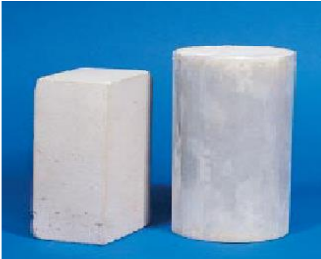
Fig. 1 Piedra de cantera de la isla de Portland (derecha) al sur de Inglaterra, a la par de un espécimen de concreto (izquierda), de ahí el nombre característico para este tipo de cemento. Imagen PCA 2004.
