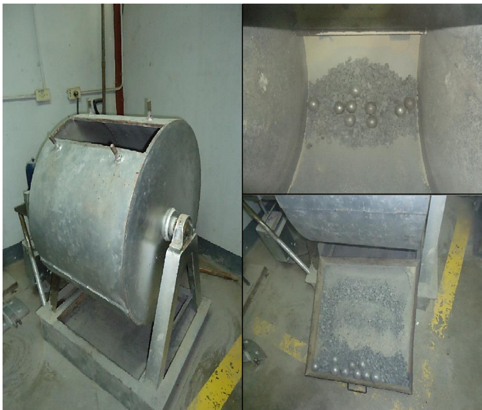
Fig. 17. Ensayo de resistencia al desgaste de los agregados gruesos, método máquina de los ángeles; laboratorio de materiales y suelos UNI-RUPAP. Imagen: Fuente propia.
