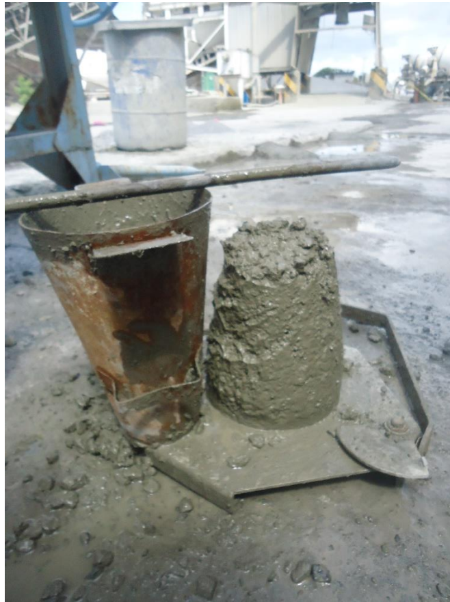
Imagen 12. Ensayo de revenimiento con cono de Abrams. Fotografía: Fuente propia.
