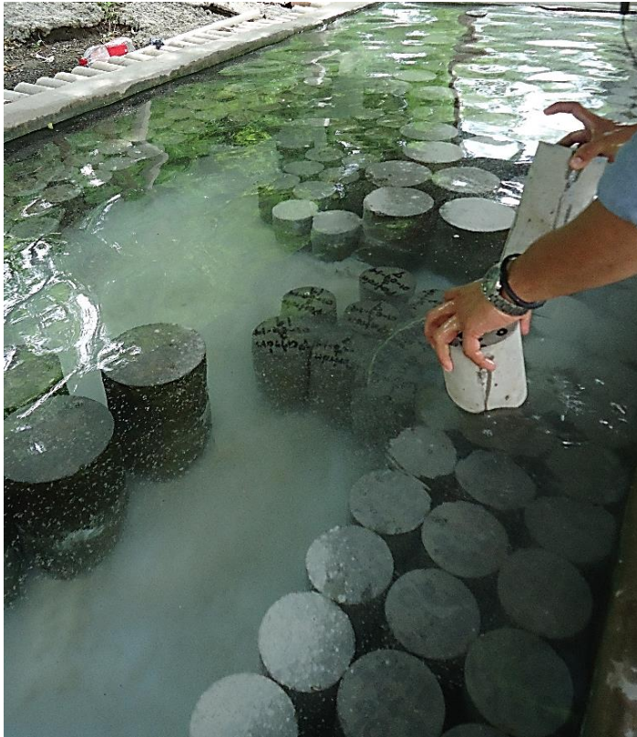
Fig. 12. Curado húmedo de especímenes de concreto. Imagen: Fuente propia.
