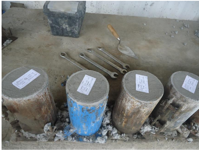
Imagen 14. Cilindros listas para desencofrarse. Fotografía: Fuente propia.
