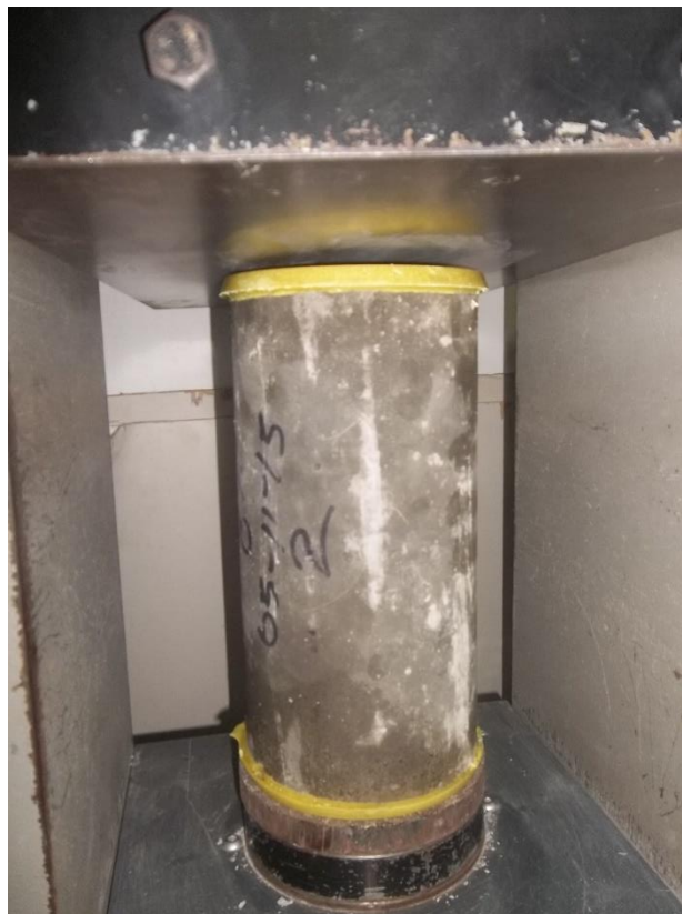
Imagen 17. Ensayo de resistencia a la compresión cilindros de 6 x 8 pulgadas. Fotografía: Fuente propia.
