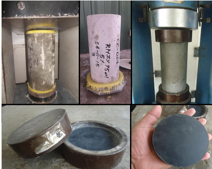
Fig. 19. Cabeceo de cilindros (mortero de azufre y almohadillas de neopreno). Fuente: Imagen propia.
