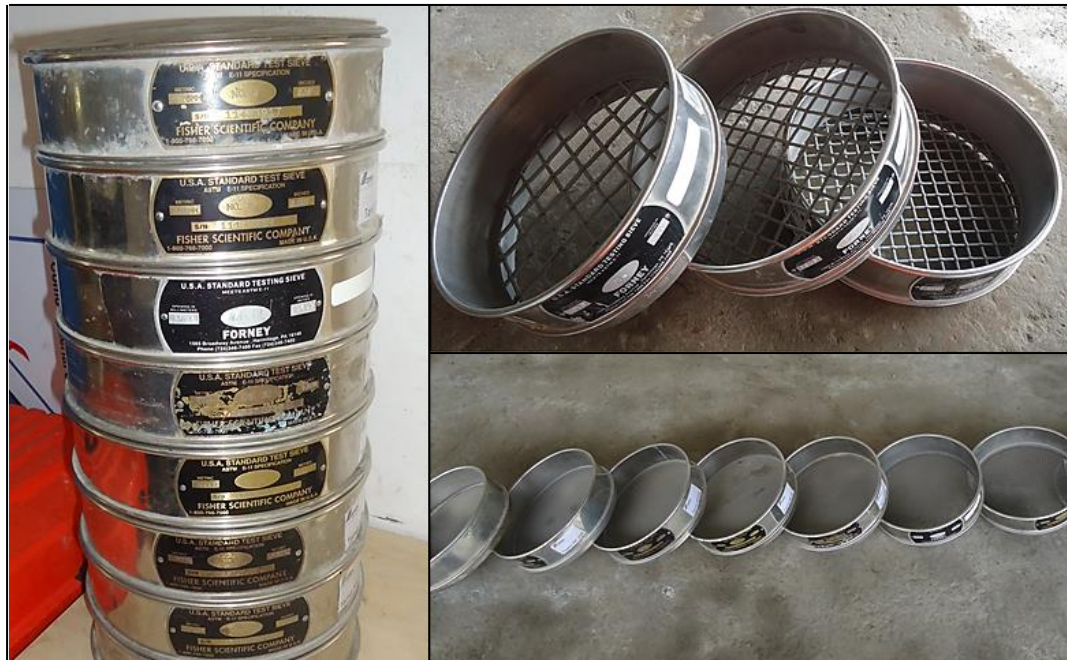
Fig. 4. Tamices estandarizados para ensayos de granulometría en agregados finos y gruesos. Fuente: imagen propia.
