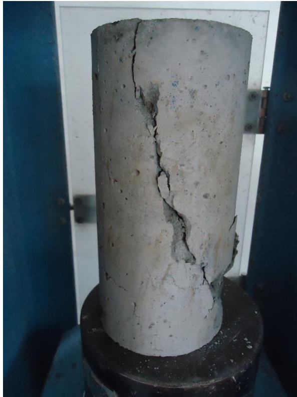
Imagen 6. Cilindro de 4 x 8 pulgadas sometido a falla por ruptura. Fotografía: Fuente propia.
