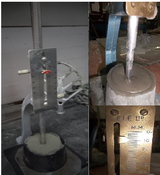
Fig. 14. Ensayo de consistencia normal del cemento hidráulico ASTM C 187. Imagen: Fuente propia.
