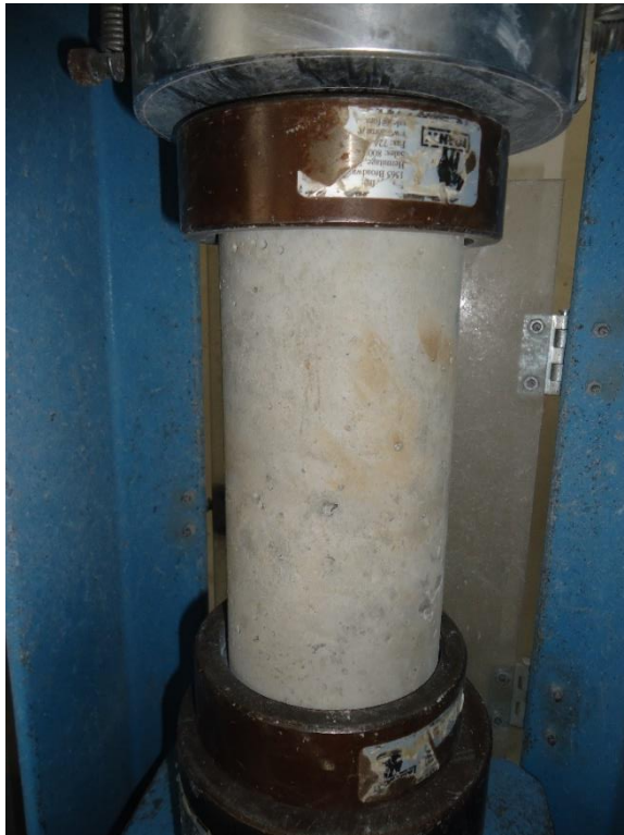
Imagen 5. Ensayo de compresión de cilindro de 4 x 8 pulgadas. Fotografía: Fuente propia.
