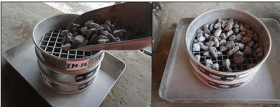
Fig. 15. Ensayo del análisis granulométrico grava \frac{3}{4} ", ASTM C136. Imagen: fuente propia.
