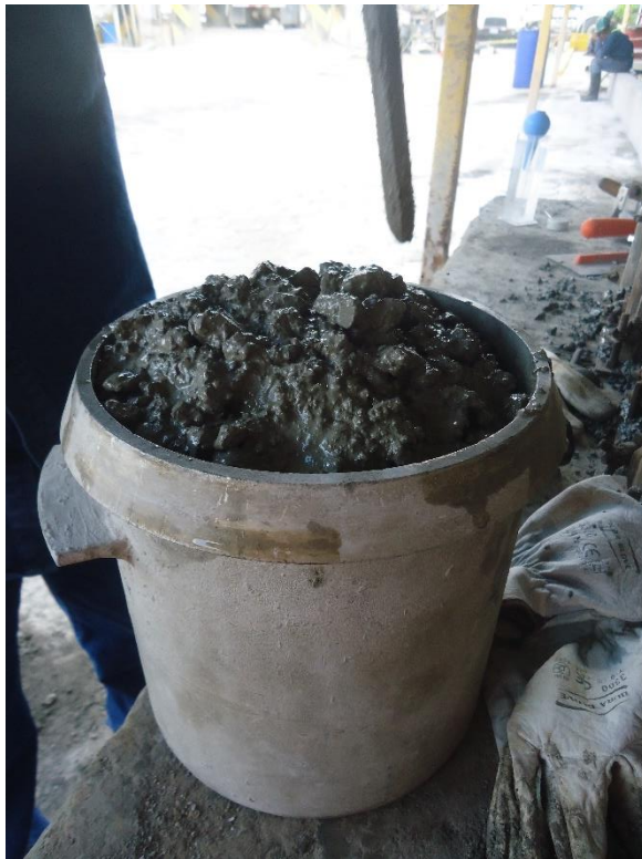
Imagen 11. Ensayo de Peso unitario concreto recién mezclado. Fotografía: Fuente propia.
