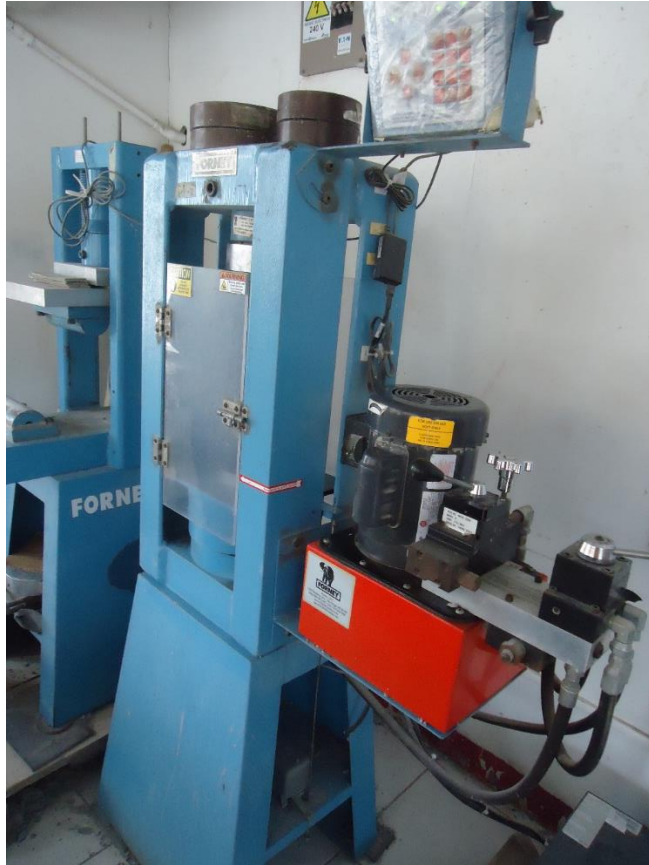
Imagen 4. Maquina de compresión de cilindros, marca FORNEY. Fotografía: Fuente propia.
