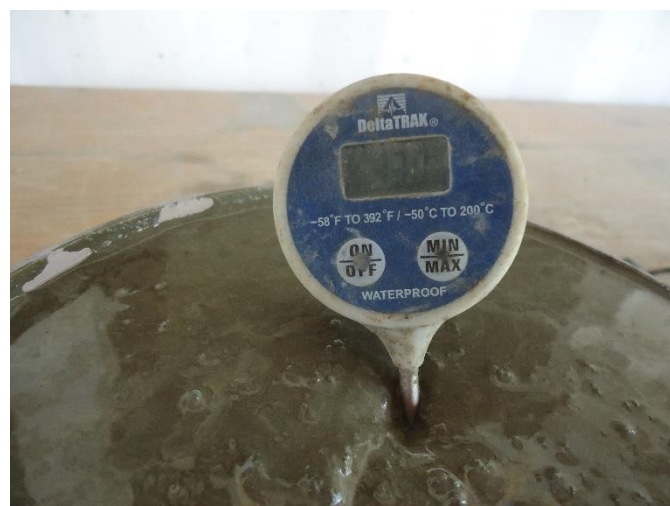
Imagen 3. Ensayo de toma de temperatura concreto recién mezclado. Fotografía: Fuente propia.
