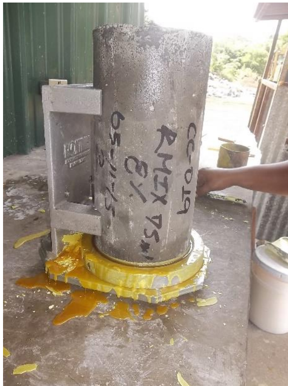
Imagen 7. Ensayo de cabeceo de cilindro de concreto de 6 x 12 pulgadas, con mortero de azufre. Fotografía: Fuente propia.
