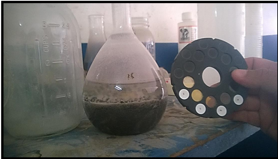
Fig. 16. Ensayo de colorimetría para material cero. Imagen: Fuente propia.
