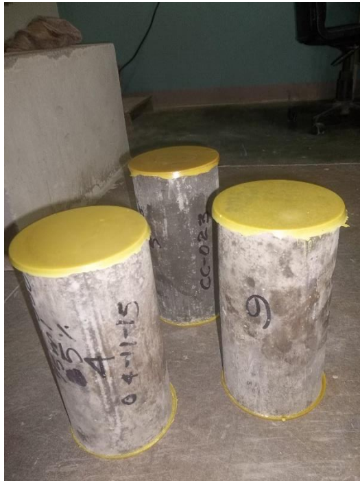
Imagen 8. Cilindros refrentados con mortero de azufre. Fotografía: Fuente propia.
