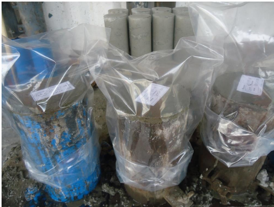
Imagen 13. Cilindros de concreto cubiertos para evitar contaminación . Fotografía: Fuente propia.
