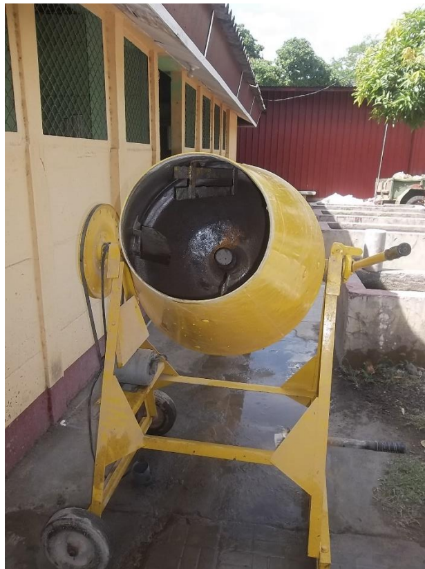
Imagen 9. Mezcladora de concreto. Fotografía: Fuente propia.
