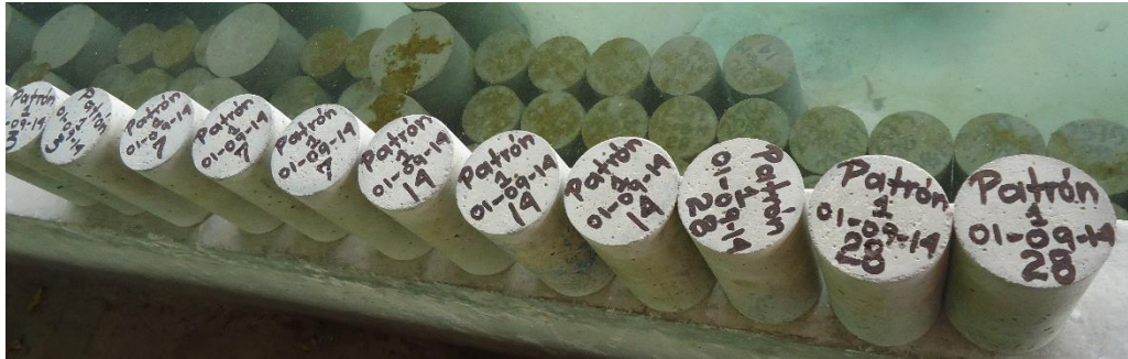
Imagen 1. Especímenes de concreto listos para introducirse en la pila de curado. Fotografía: Fuente propia.
