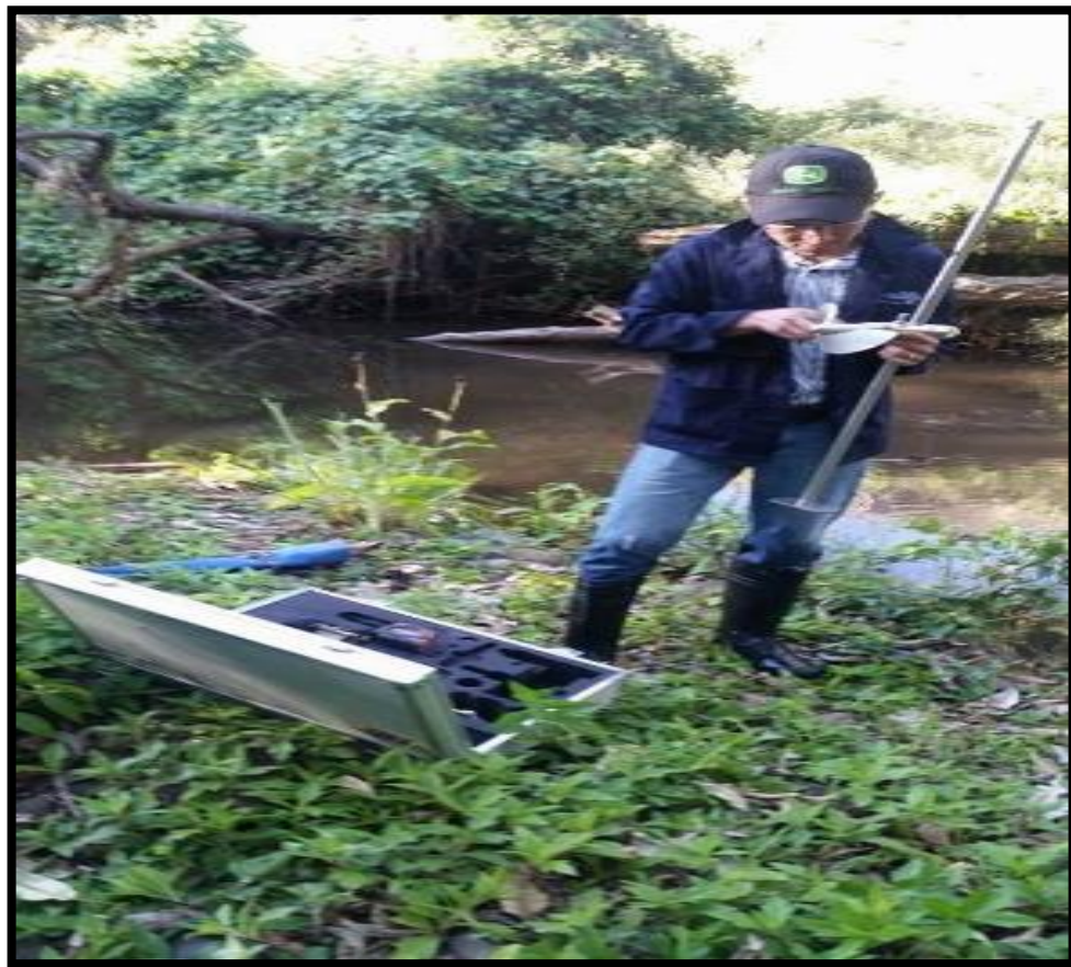
Fotografía Núm. 10 Armado de equipo de Aforo
