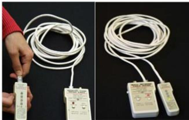
Figura 23 Referencia tester de red
