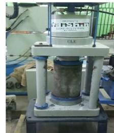
Prueba de Resistencia a la compresion
