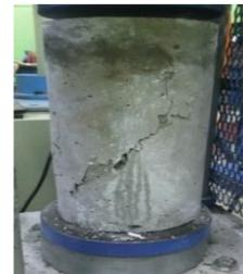
Especimnes luego de la prueba de resistencia a la compresion
