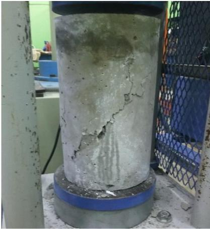
Como los resultado de resistencia lo indican los especímenes curados por ebullición no tuvo una variación relevante con respecto a los especímenes con 1 día de edad alcanzando un incremento de un 0.33 %
