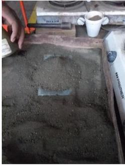
Los áridos finos susceptibles de ser utilizados en la fabricación de hormigones de alta resistencia son, casi con carácter exclusivo, los obtenidos por procedimientos naturales a partir de sus rocas de origen. Con dichos procedimientos las partículas de agregado fino presentan formas regulares, las cuales, como en el caso de las gravas, favorecen la unión con la pasta de cemento.
