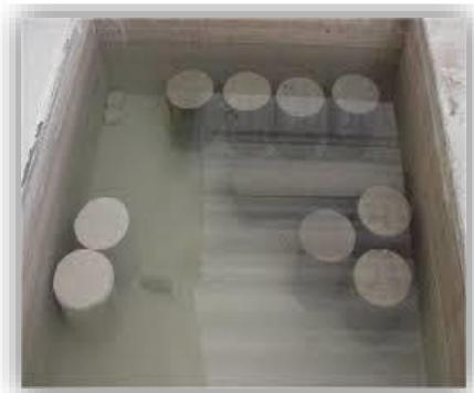
con agua permaneciendo sumergidos hasta que cumplan con el tiempo de curado, por lo general para pruebas de compresión se ensayan a los 7,14 y 28 días
