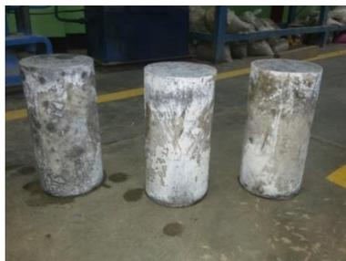
Al terminar el proceso de curado del método acelerado del concreto hubo un cambio en sus características físicas, esta diferencia fue que presentaba partículas blancas que se desprendían de él y manchas en la parte superior del espécimen.
