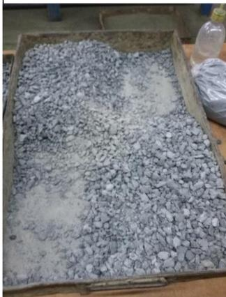
Los agregados gruesos son materiales inertes que mezclados con cemento portland en presencia de agua conforman el concreto u hormigón; estos agregados que tienen una resistencia propia que no afectan las propiedades y características del concreto, por el contrario, garantizan una adherencia suficiente.
