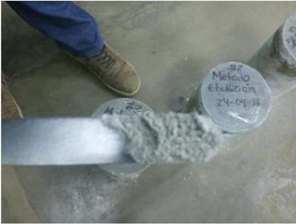
transcurrida las 3.5 horas de ebullición). Se logró observar la presencia de polvo blanco debido a la desintegración de la superficie del concreto.
