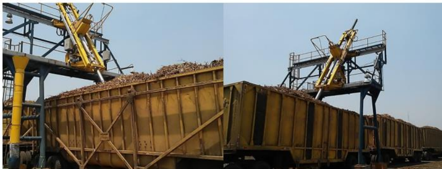
Figura 6.4. Sonda perforadora en acción, aplicada desde distintos puntos y a diferentes profundidades.
