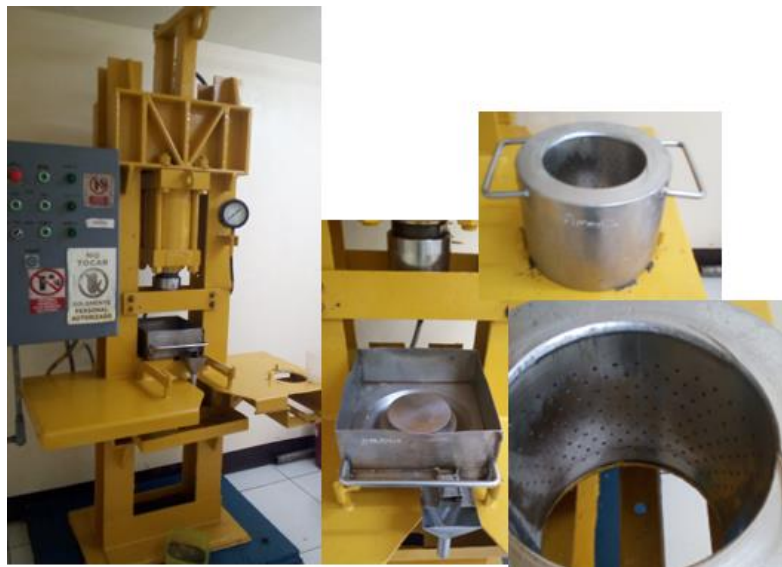
Figura 5.3. Sistema Prensa hidráulica y tazón horadado.
