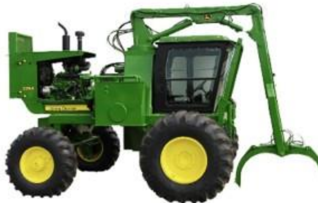
Figura 6.1. Alzadora o Cargadora para muestreo de recepción de caña.
