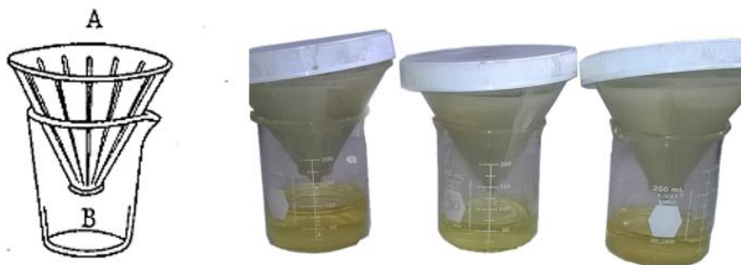
Figura 5.4. Dispositivo de filtración (A: embudo y papel filtro; B: vaso de precipitado) y muestra filtrada. De izquierda a derecha respectivamente.
