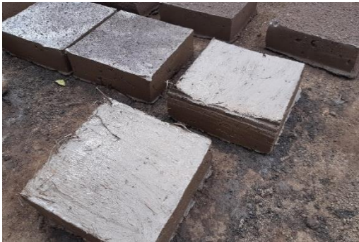
Imagen 55. Pruebas de Adobes con Diferentes Dosificaciones.
