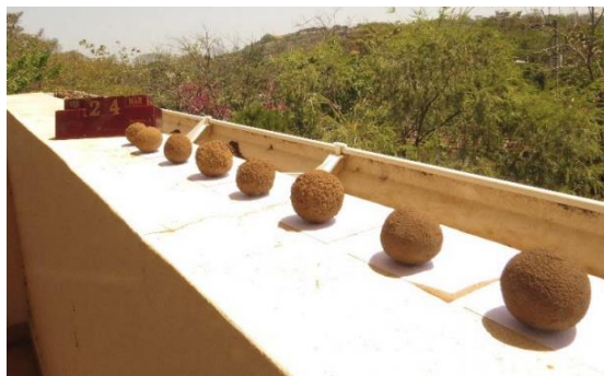
Imagen 12. Muestras de Prueba de la Bolita. Fuente: DMG Gráfico 03. Prueba de la Bolita. Fuente: Manual del Salvador.
