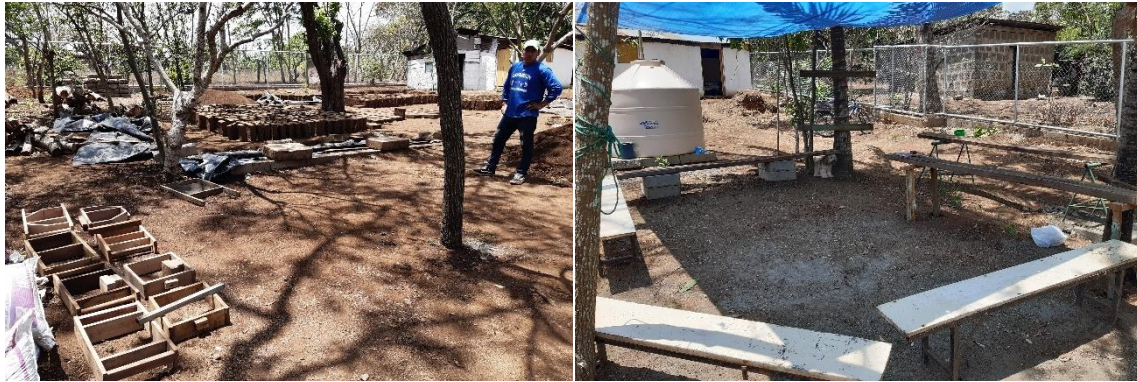
Imagen 81. Muestras de Gradillas para Fabricar Adobes en Taller.
