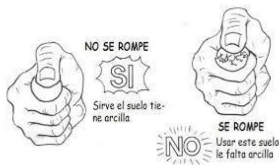
Imagen 12. Muestras de Prueba de la Bolita. Fuente: DMG Gráfico 03. Prueba de la Bolita. Fuente: Manual del Salvador.
