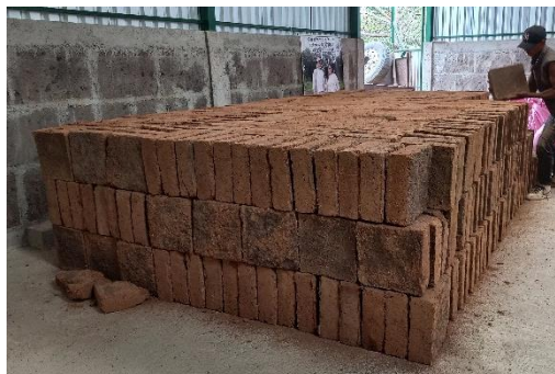
Imagen 17. Correcto Estibado de los Adobes (máximo 3 Hiladas).
