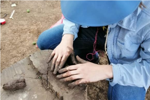
Imagen 51. Haciendo Prueba del Rollo.
