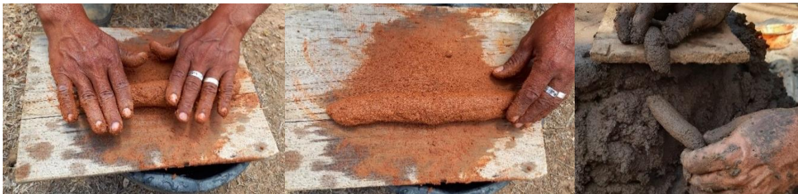
Imagen 10. Proceso de la Prueba del Rollo para Identificar la Cantidad de Arcilla o Arena que Contiene la Tierra.
