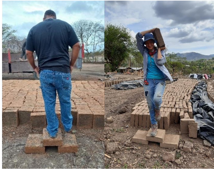
Imagen 16. Prueba de la Resistencia para comprobar la calidad de los Adobes.
