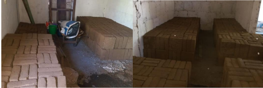
Imagen 65. Adobes Estibados de Canto en Bodega Temporal
