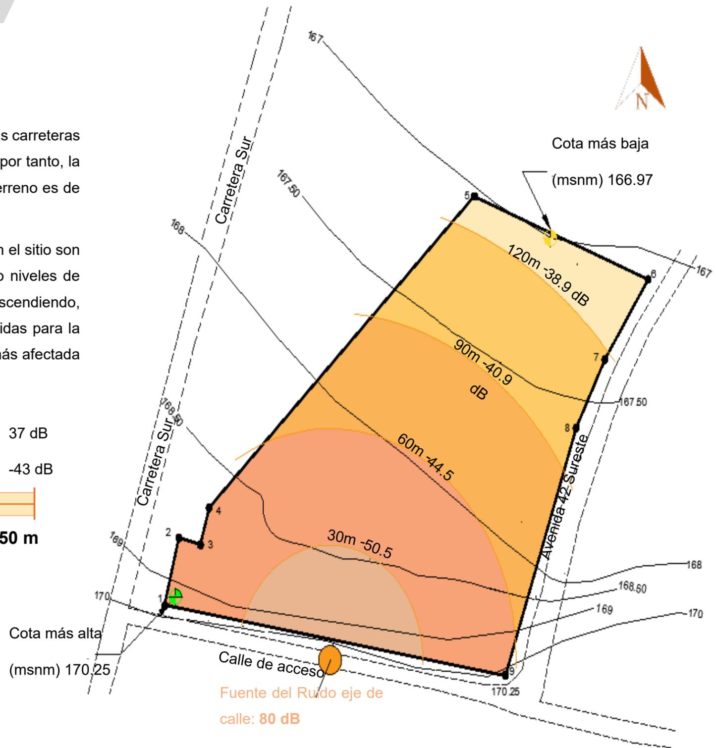
Ilustración 88 Plano de atenuación del ruido de fondo (proviene del acceso de la carretera Sur). Fuente: Surface 10 y editado por autores.
