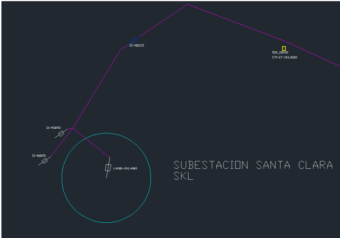
Figura 8: Representación de la red SKL4020 en AutoCAD 2019. Fuente: Elaboración propia a partir de datos extraídos de BDI.
