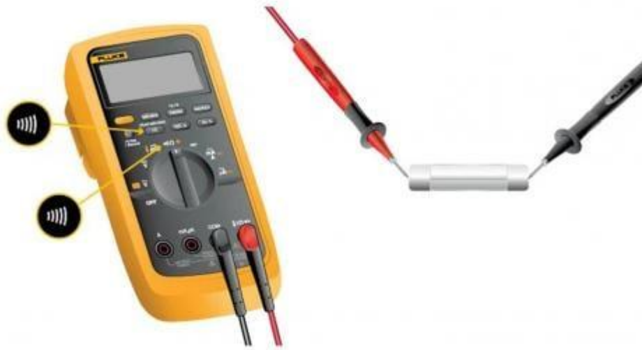
Ilustración 26 Multímetro y prueba de continuidad (Fuente Propia)
