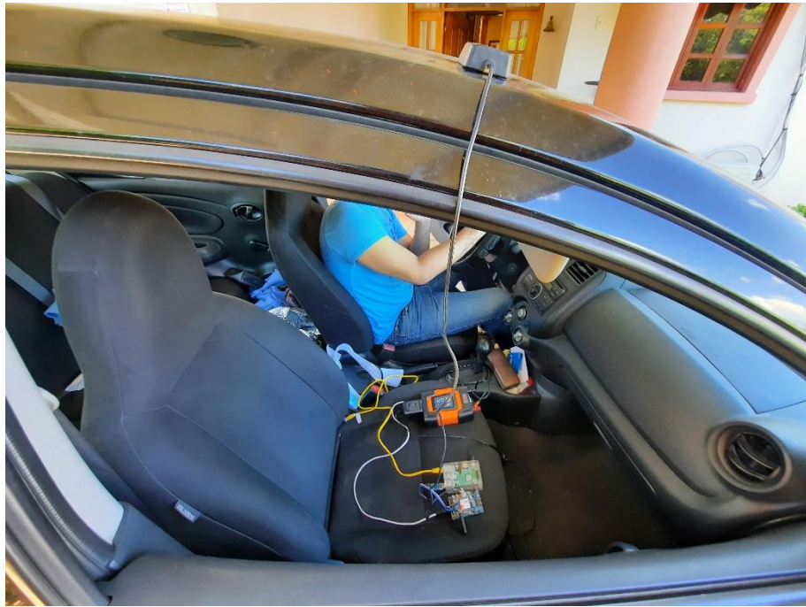
Ilustración 35: Módulo GPS instalado en vehículo de pruebas.
