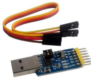
Ilustración 8: CP2102 Adaptador USB a TTL
