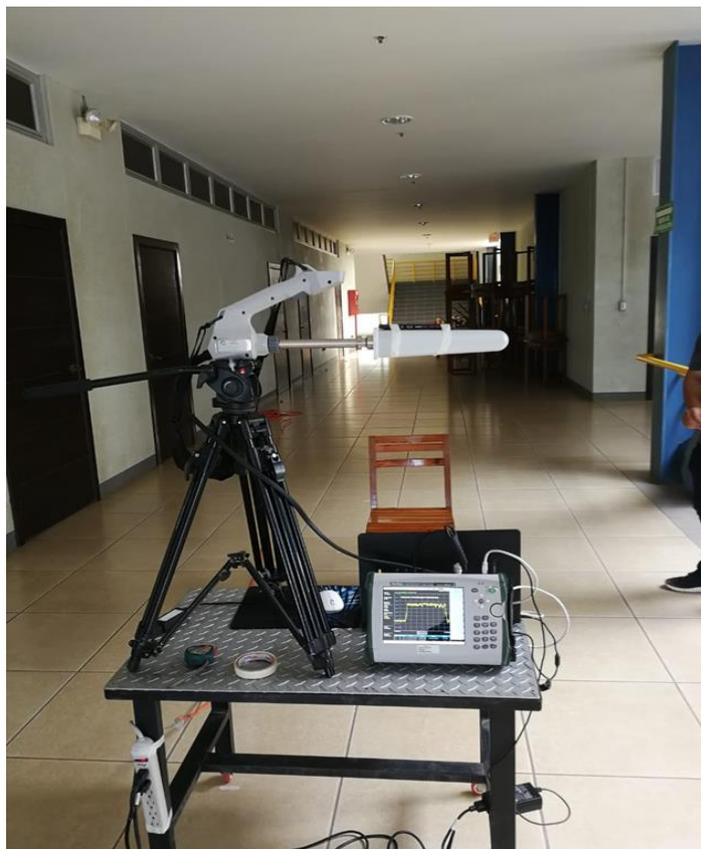
Figura 15. Banco de mediciones analizador de espectro
