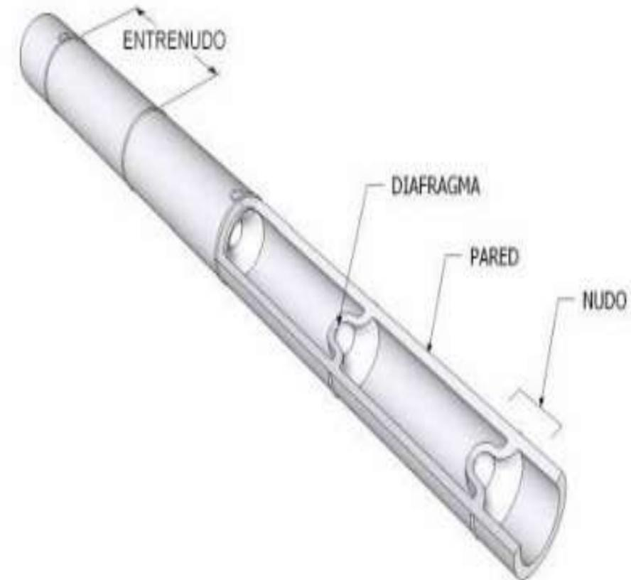
Figura 117: Partes de las cañas del bambú. Fuente: Manual del Bambú
