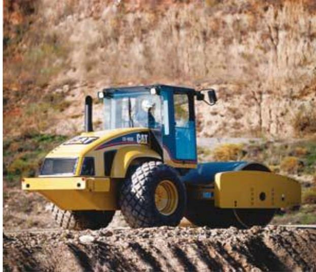
**Imagen 4.2 Compactador y vibrador.**
