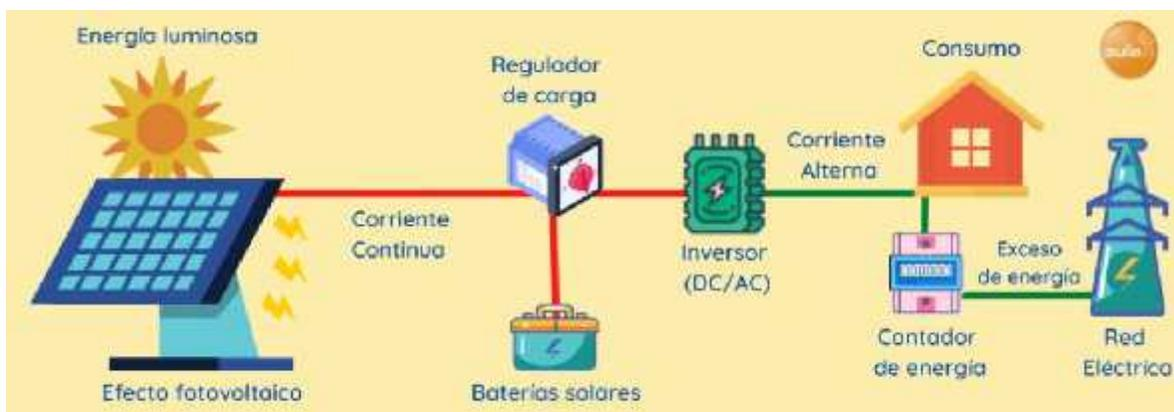
Figura 1. Ejemplo de instalación de energía fotovoltaica de autoconsumo. [6]
