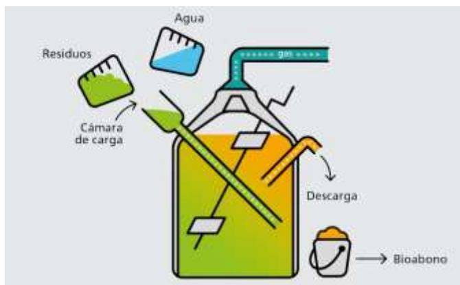
Fig.16. Operación de un Biodigestor. (Instituto Multidisciplinario de Energía, s.f.)
