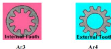
Las arandelas Ar3 y 4 sirven para mejorar no solo el agarre, también la conexión eléctrica. Use una arandela plana sobre una Ar3 o Ar4 para que resvale fácilmente la tuerca al rotarla. Las indentaduras se entierran en el cuerpo de cobre de un conector, asegurando un buen contacto.
