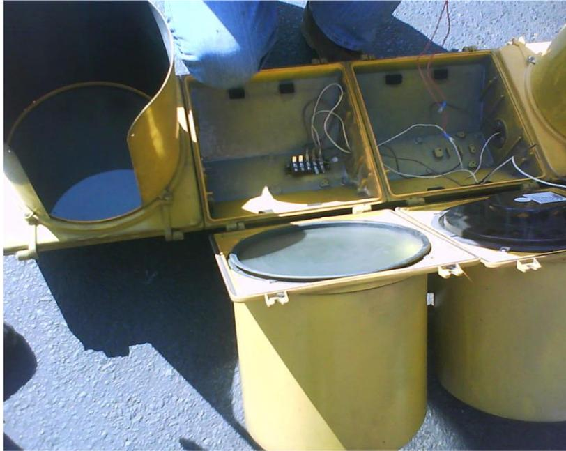
**Lente:** Es la parte de la unidad óptica que por refracción dirige la luz provenientes de los LED y su reflector en la dirección deseada.
