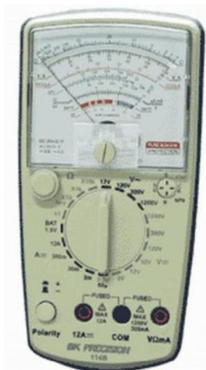
**Figura 13.4- Multi-meter analógico (B&K Modelo 114B)**
