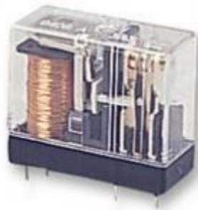
El **relé** (o relevador) es un dispositivo electromecánico, que funciona como un interruptor controlado por un circuito eléctrico en el que, por medio de un electroimán, se acciona un juego de uno o varios contactos que permiten abrir o cerrar otros circuitos eléctricos independientes.
