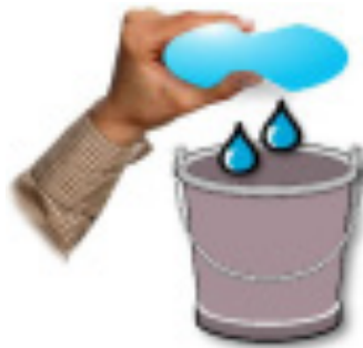
Fig. 3.7 La relación de humedad compara el vapor de agua con el aire seco, por el peso.
