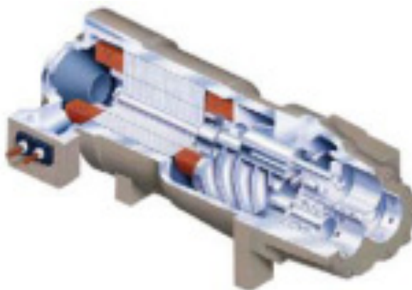
Fig. A-6 Rotores de un compresor de tornillo.
