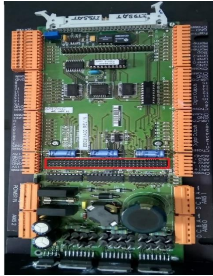
Figura 4. Tarjeta de control de la máquina CNC Fuente: (Elaboración propia).
