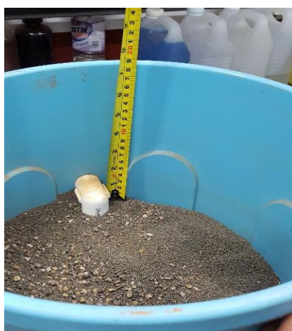
d. Altura del balde hacia arena 19 cm
