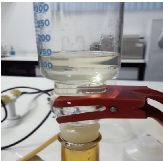
Figura 11 Filtración de agua cruda haciendo uso de Kitasato
