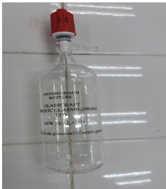
Figura 12: Bulbo de Giggenbach de 300 mL de capacidad para tomas de muestra de vapor.
