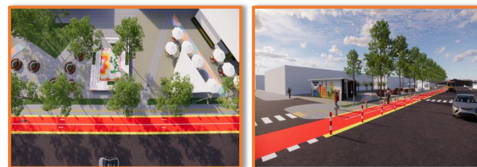
Ilustración 97 Propuesta de ciclo vía en tramo vial
