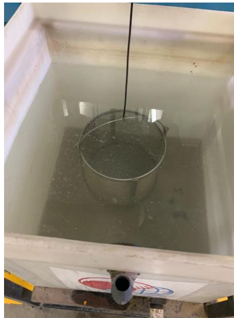
Ilustración A-2. Determinación de la gravedad específica de la grava - Método hidrostático
