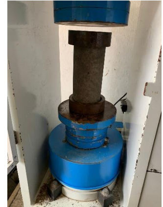
Ilustración 7. Ensayo de Resistencia a la Compresión
