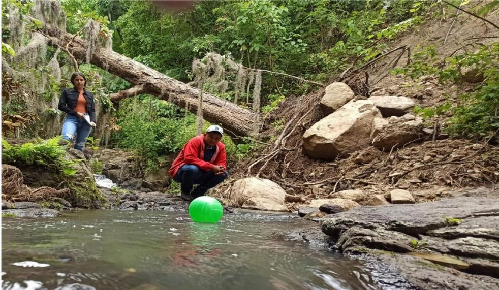
**Fotografía 4. Aforo y medición de la fuente**
