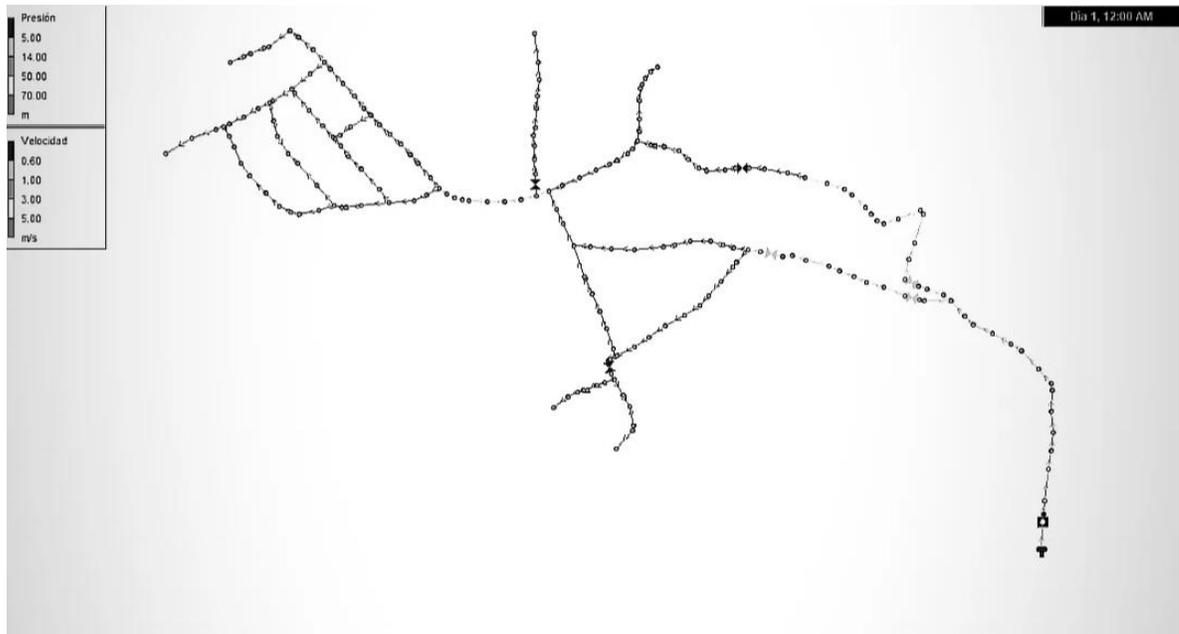
A cada uno de los elementos (nodos y tubería) se les asignó sus datos específicos (elevación y caudal a los nodos, longitud de las tuberías) para generar la simulación de todo el sistema para verificar presiones y velocidades.
