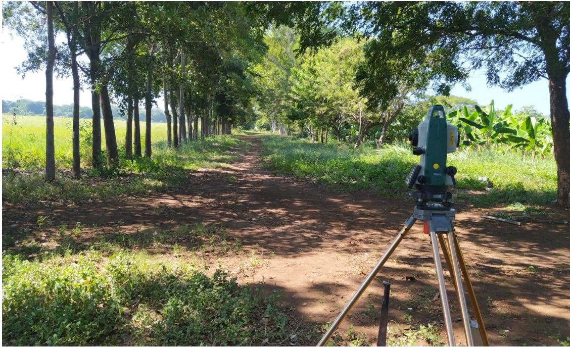
Figura 16. Levantamiento topográfico con estación total Sokkia
