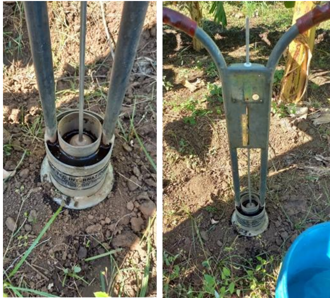
Figura 15. Prueba de Infiltración
