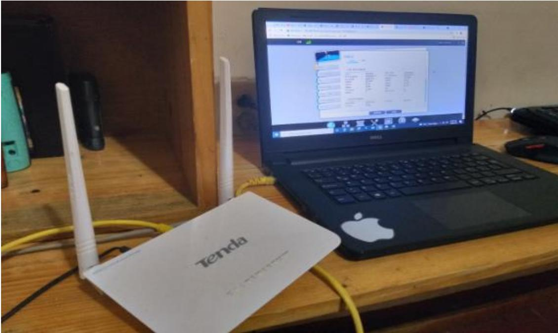
Fig. No. 37 Conexión entre el ordenador y el Router mediante cable de red
