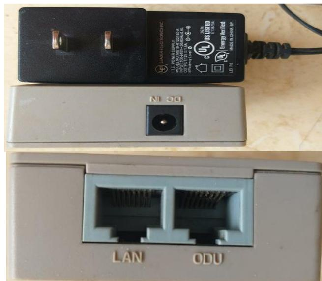
Fig. No. 30 Puertos del POE y Fuente de carga
