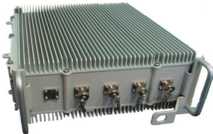
Fig. No.18 Unidad de estación base Air4G, puertos RF [23]
