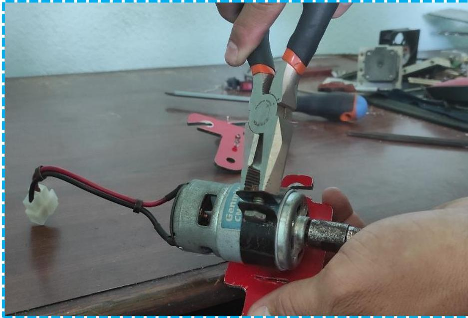
Figura 22: Soporte del motor de corte.
