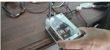
Figura 71: *Armado de caja para arduino.*
