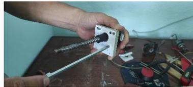
Figura 74: *Fijado de piea de soporte de motor de paso en el eje Z.*
