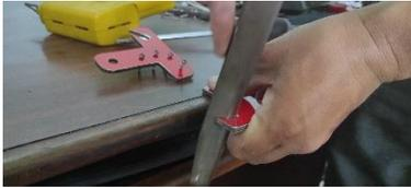
Figura 70: *Corte de piezas de fijacion de eje X y Z.*
