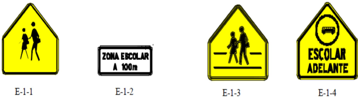
Figura 12. Señalización vial preventiva
