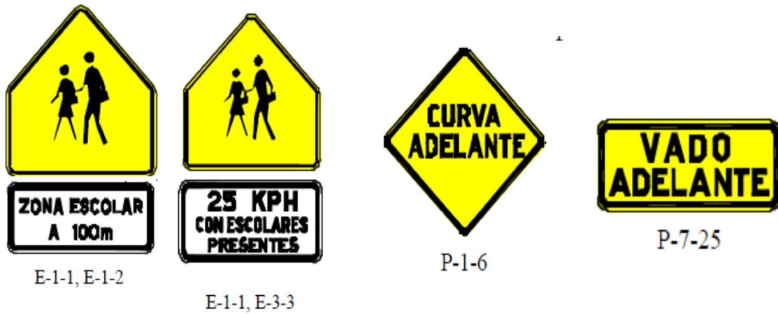
Figura 13. Señalización vial preventiva
