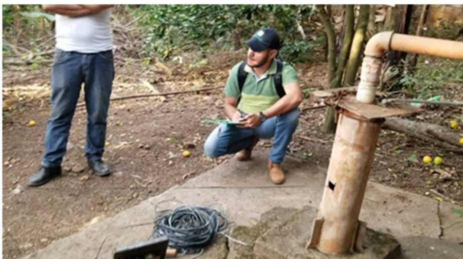
Ilustración 19: Toma de datos de los niveles del pozo con sonda electrónica
