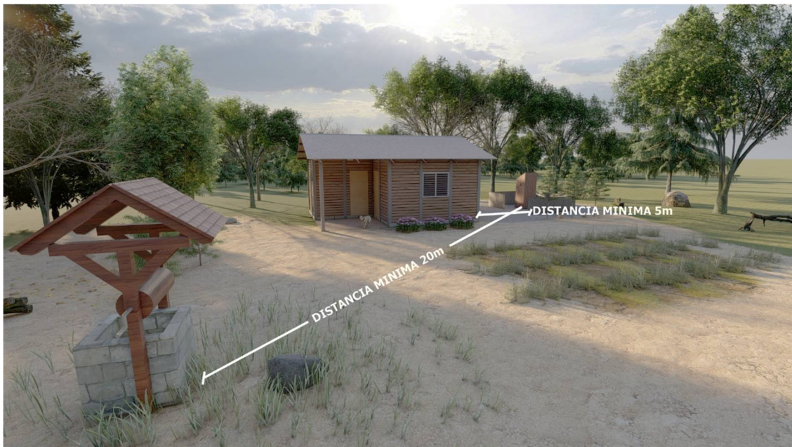
Ilustración 13: Ubicación recomendada de las letrinas de foso ventilado
