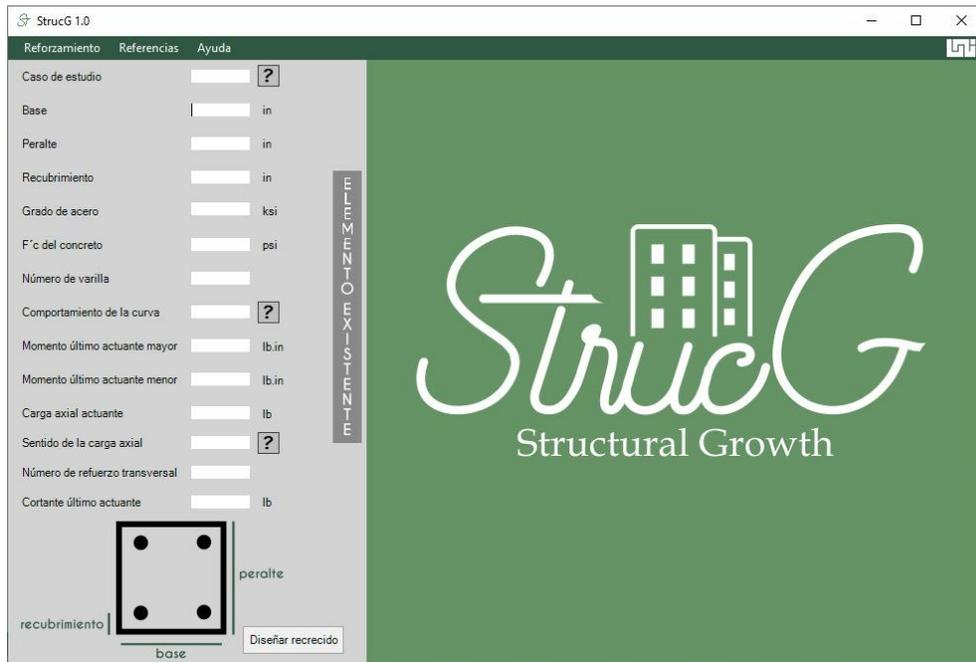
Ilustración 6-36 - Entrada de datos para columna flexo compresión esbelta
