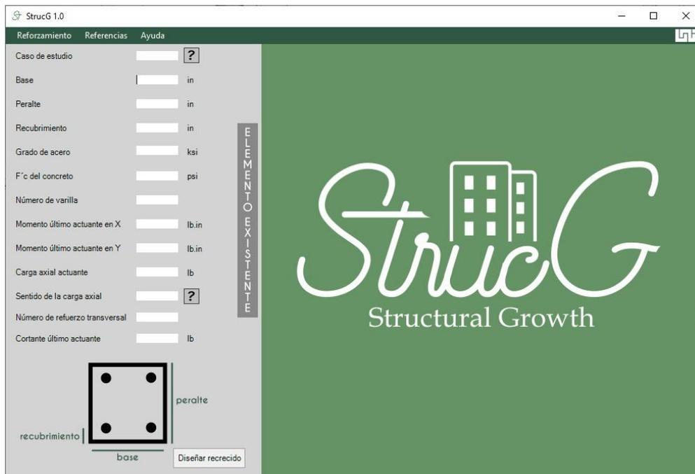
Ilustración 6-38 - Entrada de datos para columna flexo compresión biaxial
