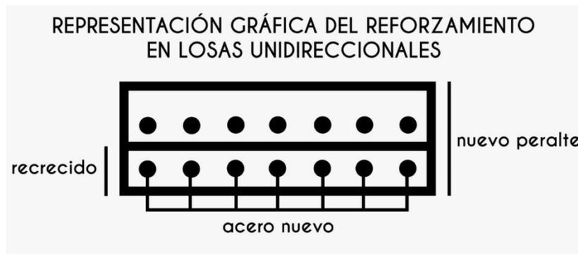
*Ilustración 3-35 - Representación gráfica de la nueva sección con el acero de refuerzo, losa convencional, recercado de hormigón*
