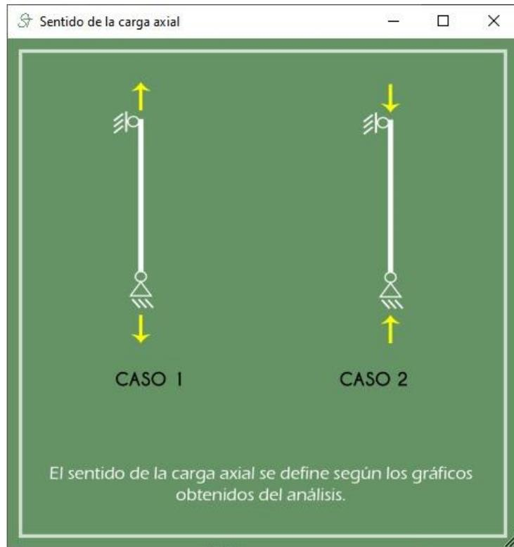
Ilustración 6-31 - Continuación, Sentido de la carga axial, columna convencional
