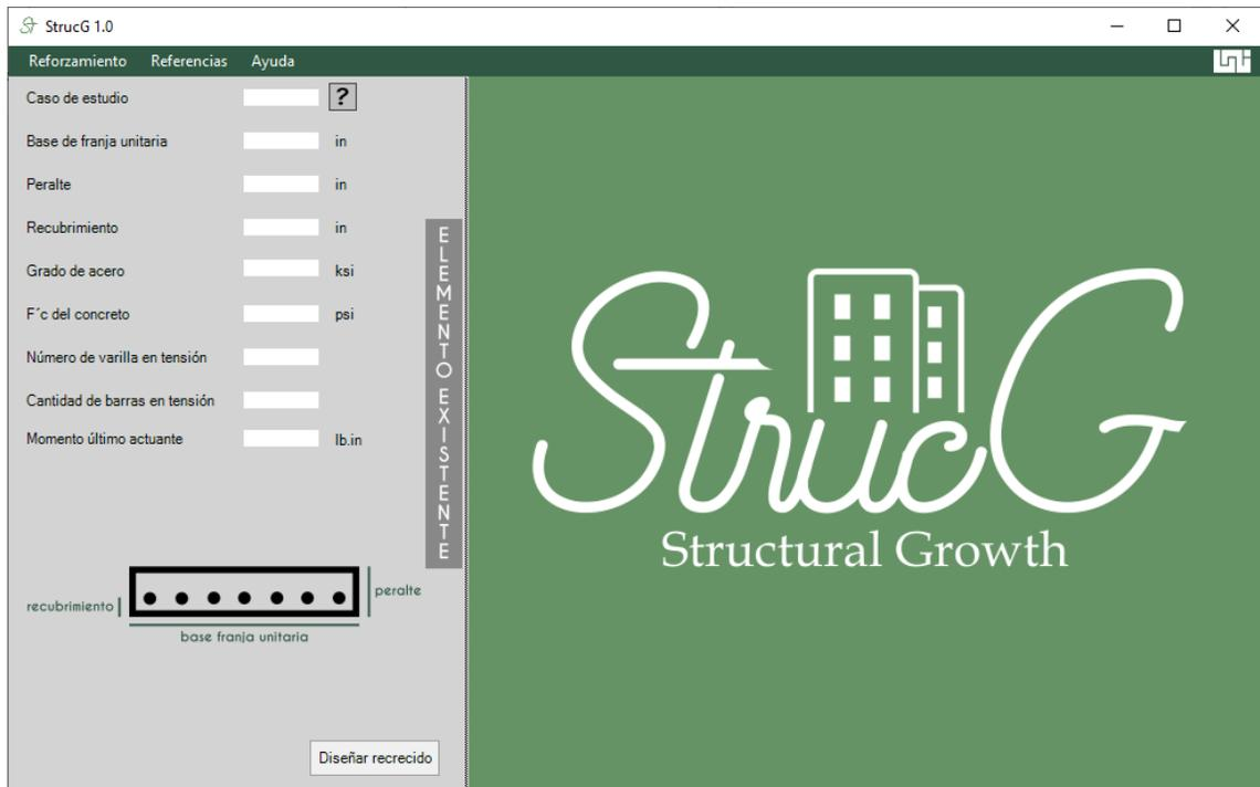
Ilustración 6-40 - Entrada de datos para reforzamiento en losa
