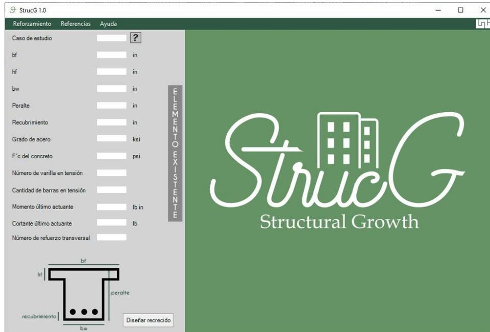
Ilustración 6-20 - Entrada de datos para vigas T
