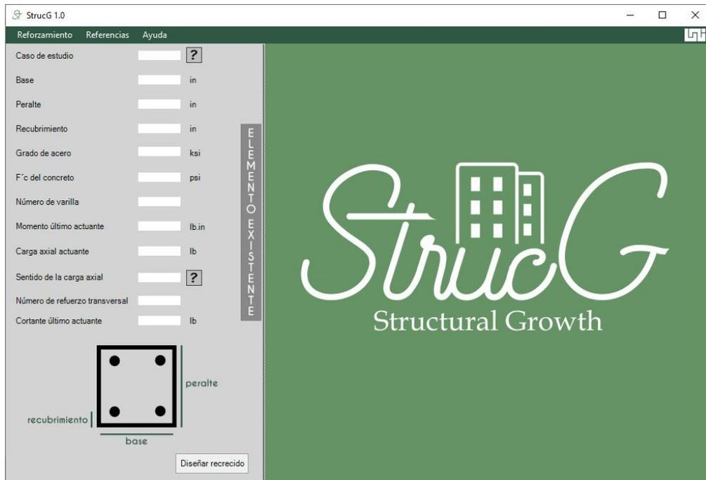
Ilustración 6-34 - Entrada de datos para columna flexo compresión corta
