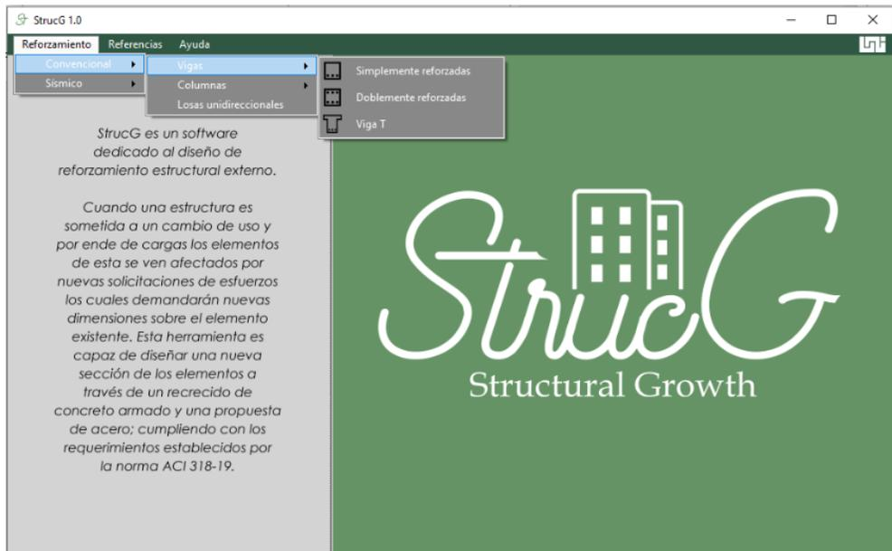
Ilustración 6-10 - Menú del reforzamiento para vigas
