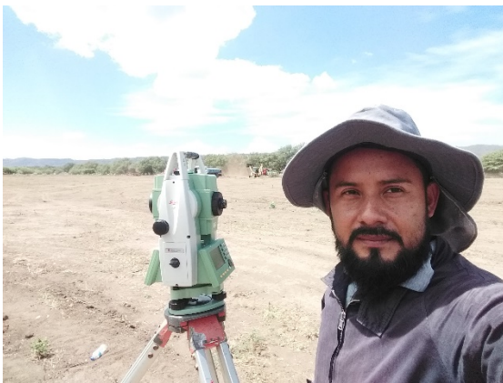
IMAGEN A 3 – Levantamiento topografico con estación total Leica TS09
